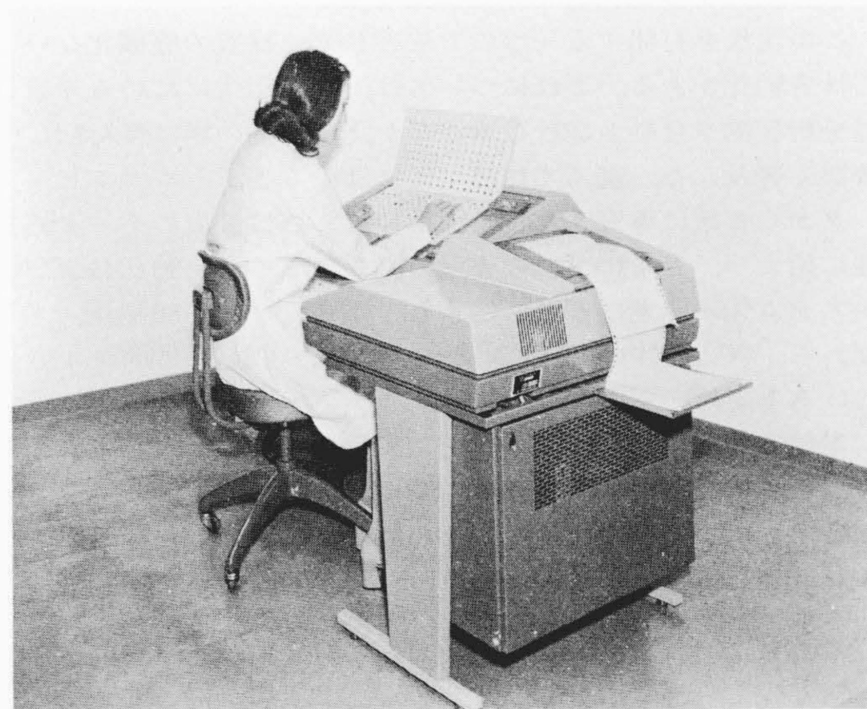
図13 HITAC 9904形キーセット端末装置 本端末装置はトークンカードを読み取るトークンリーダ部と、16×10のキーを持つキーセット部より成り、ワンタッチで多種多様なデータを入力することができる(写真手前はプリンター)。
