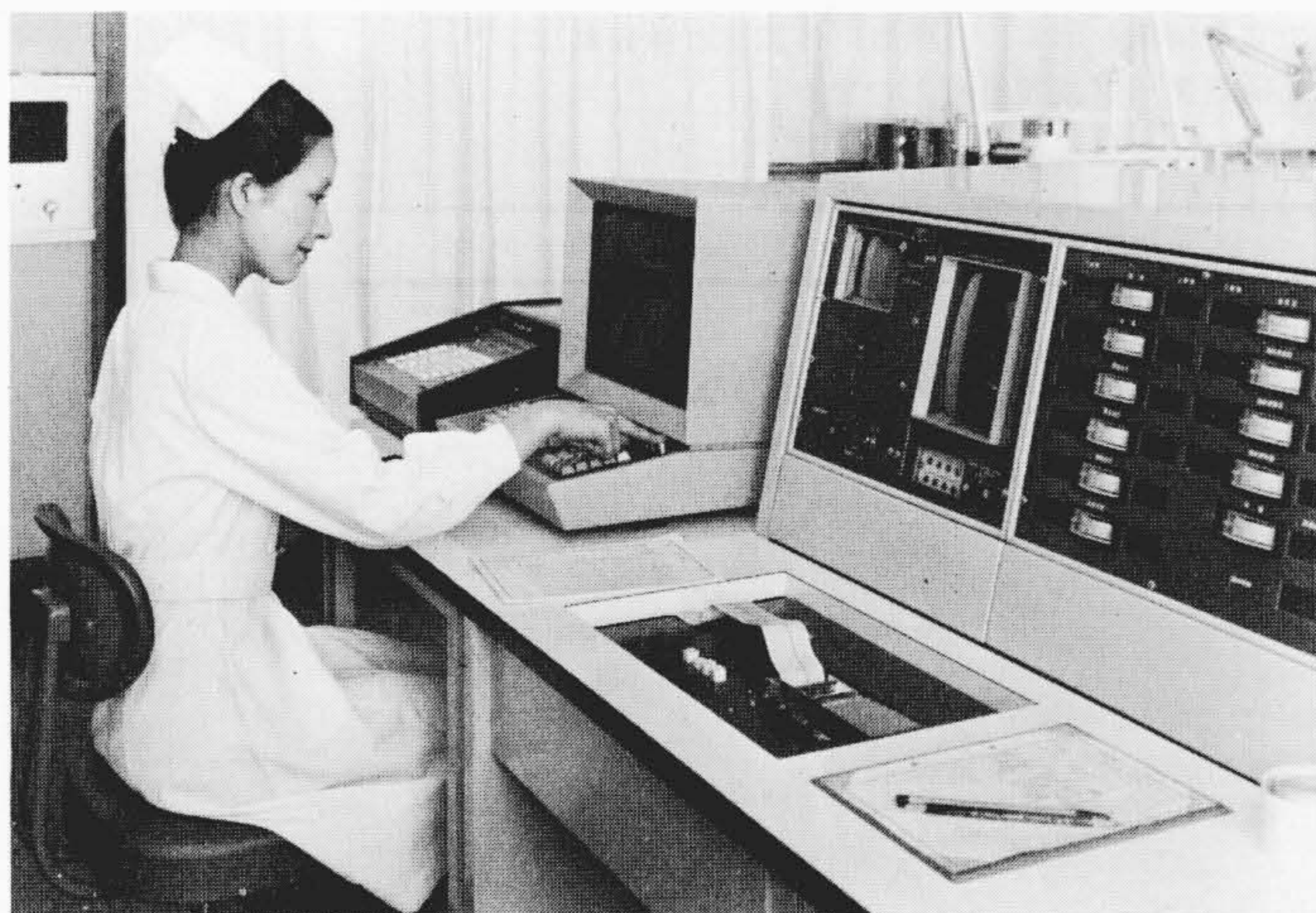
図4 人工腎臓患者監視システム 透析室モニタ 人工腎臓患者監視システムのうちの透析室に設置するモニタの外観を示す。写真は看護婦がキャラクタディスプレイで対話形式でイニシャルセットをしているところである。
