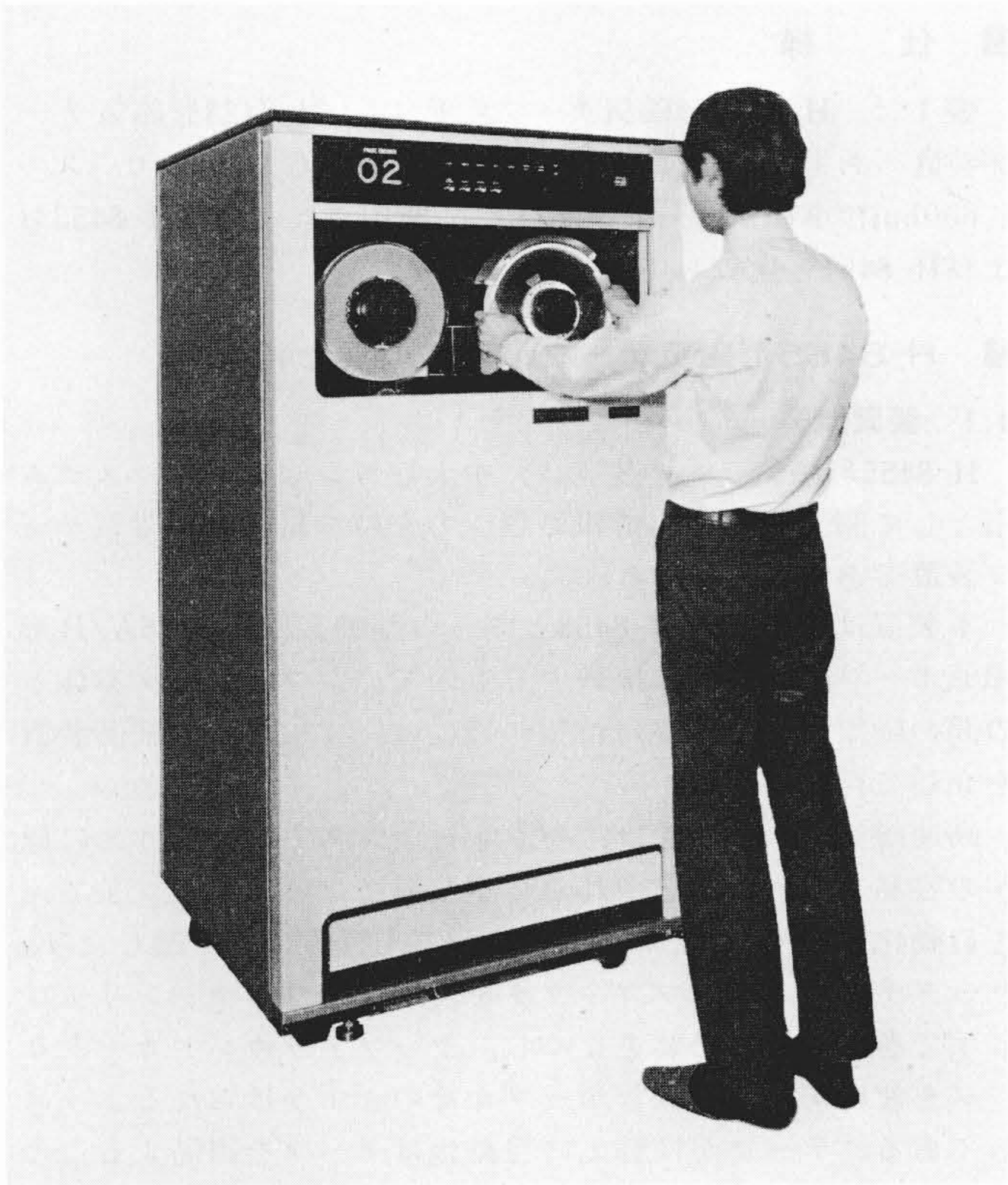
図 I H-8455形磁気テープ装置 テープ自動装てん機構持ち、1筐体に一つのテープ走行機構部を収納している。
