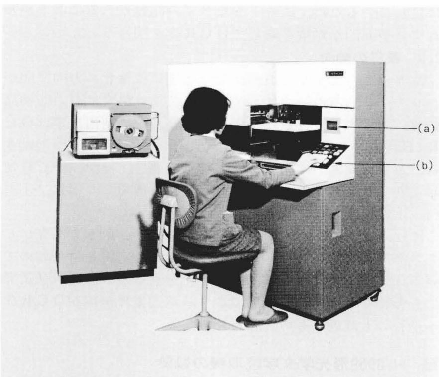
図1 H-8959光学文字読取機 機械で読めない文字は(a)のディスプレイ部に表示されるので、それを人間が読んで(b)の部分からキーボードをする。
