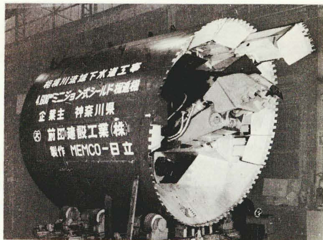
図42 MEMCO-日立ミニジョン式シールド掘進機
