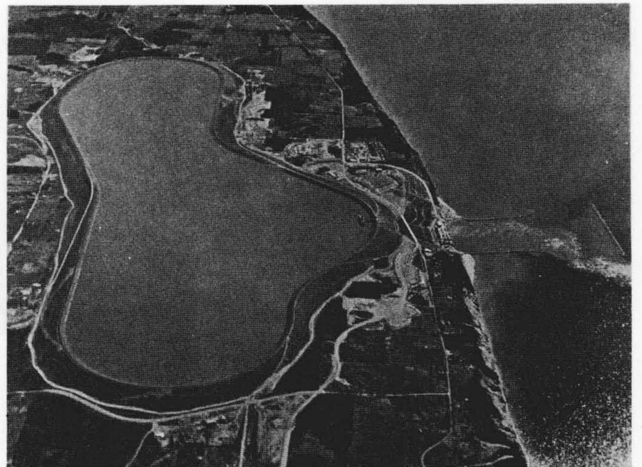
図1 アメリカ、ラディングトン発電所全景 水車運転中の発電所航空写真である。左手の上部貯水池は人工湖、右手下部貯水池はミシガン湖をそのまま使っているものである。
