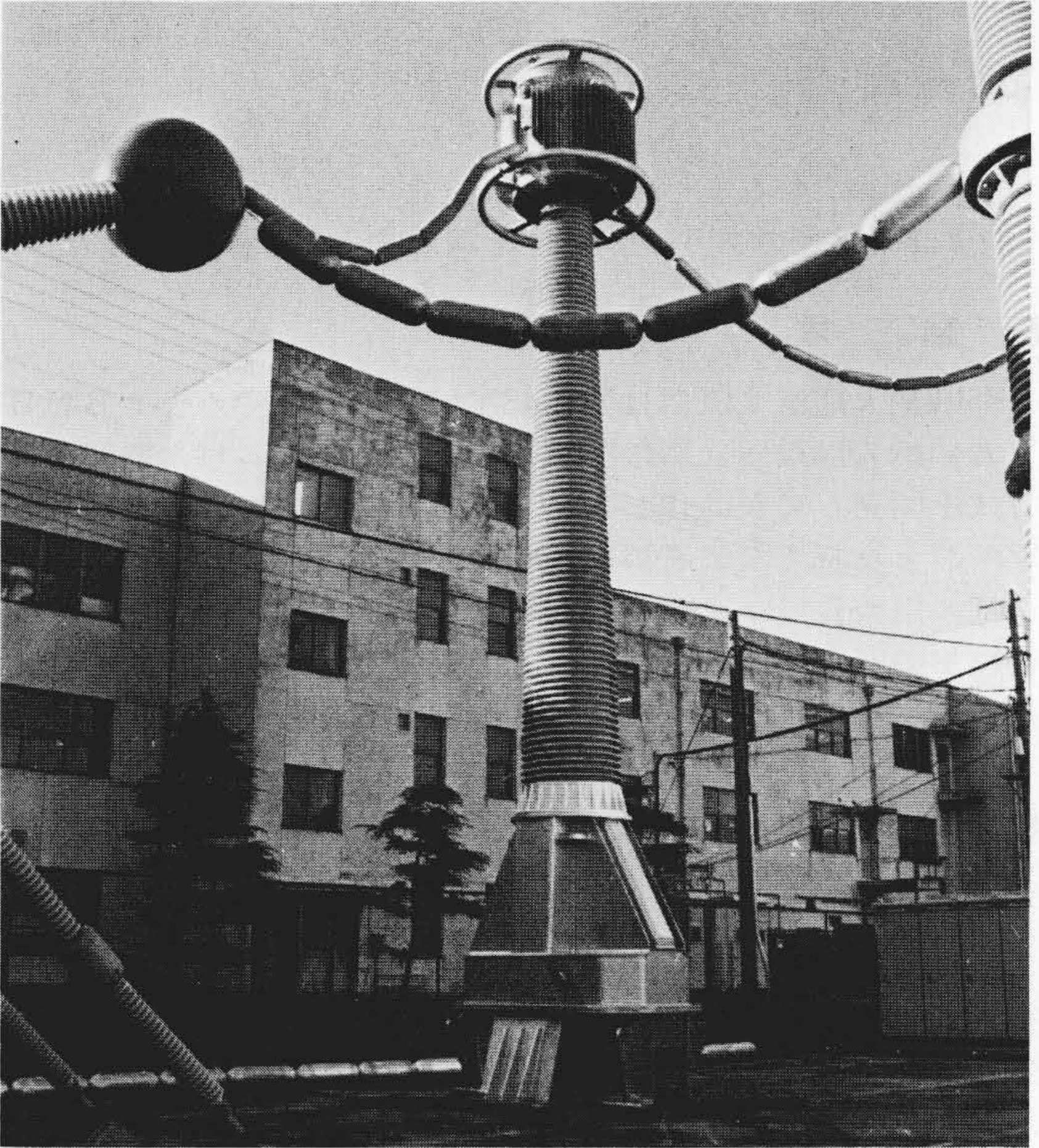
図10 関西電力株式会社納め550kV 4,000A正立内部冷却形変流器 6.5mがい管を使用した550kV 4,000A変流器に長期課電試験を行なった。 Fig. 10 550kV 4,000A Current Transformer for Kansai Electric Power Company Ltd.
