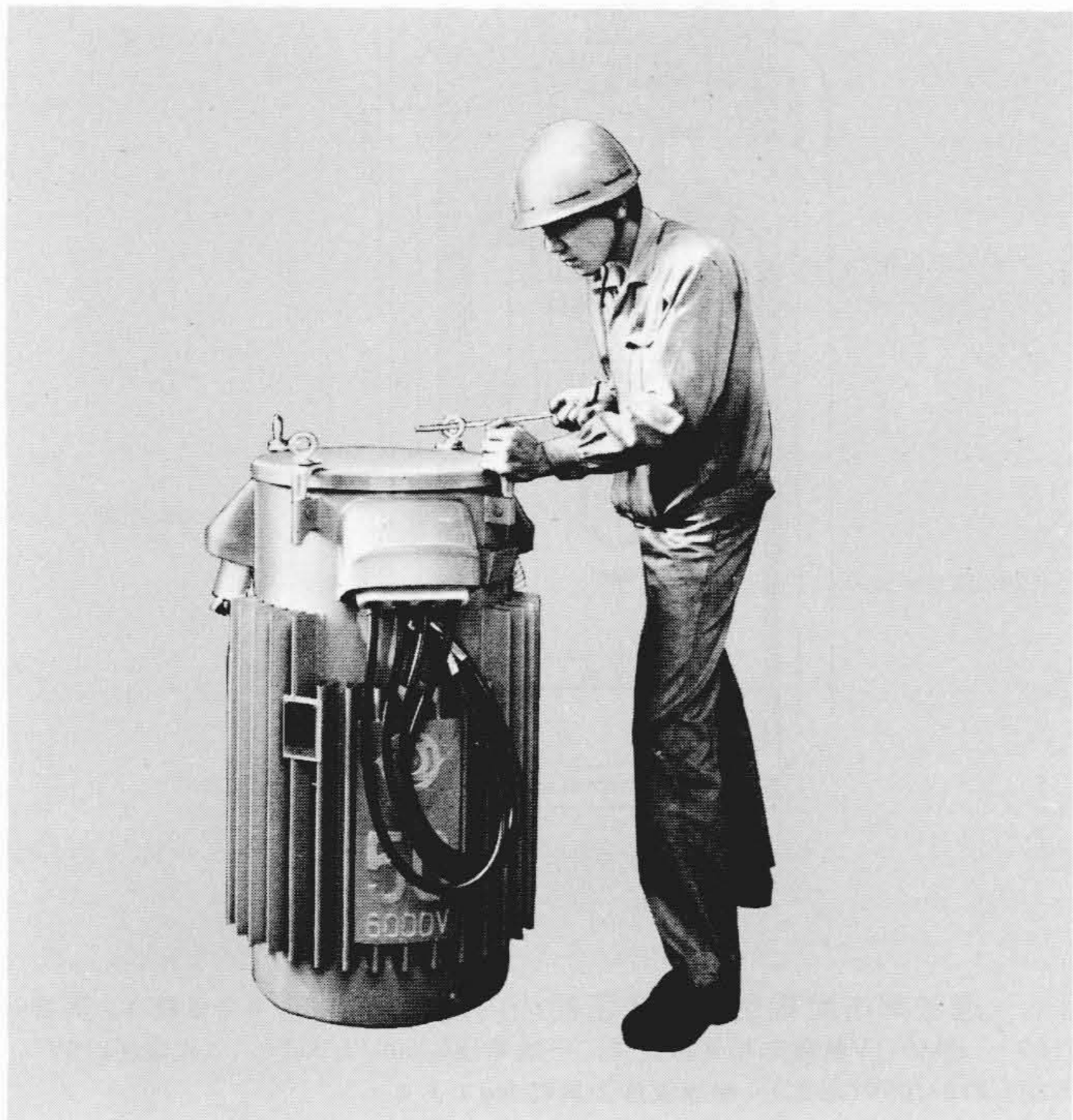
図2 標準形柱上変圧器の一例 現在多用されている柱上変圧器の一例として単相50Hz 6kV級50kVAの外観を示す。高压ブッシングはスタット方式であり、高压引下線を磁器製のハンドルにて締め付ける構造である。
