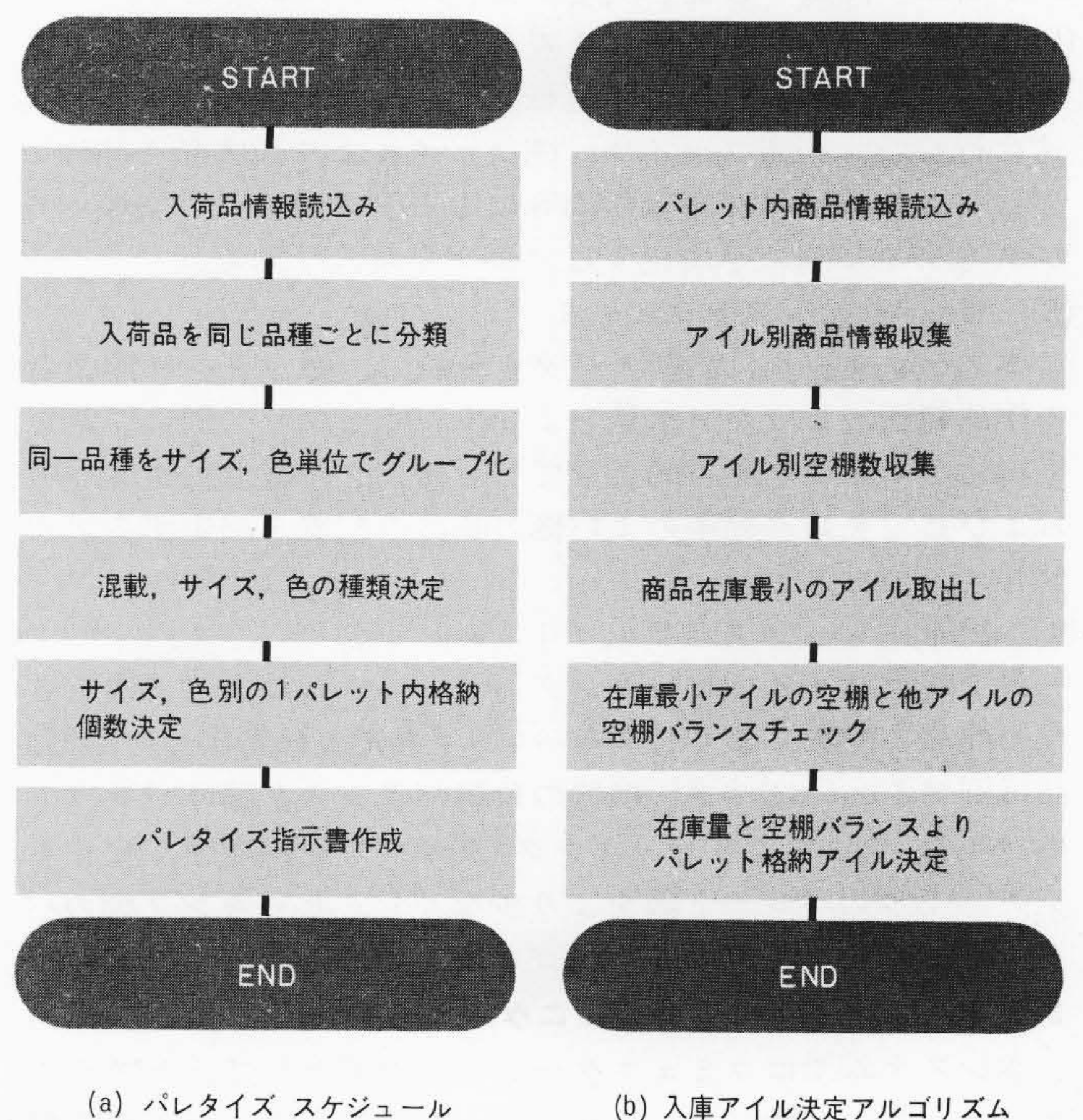
図9 丸紅繊維流通センター入庫運用アルゴリズム 入庫運用アルゴリズムの処理流れを示す。
