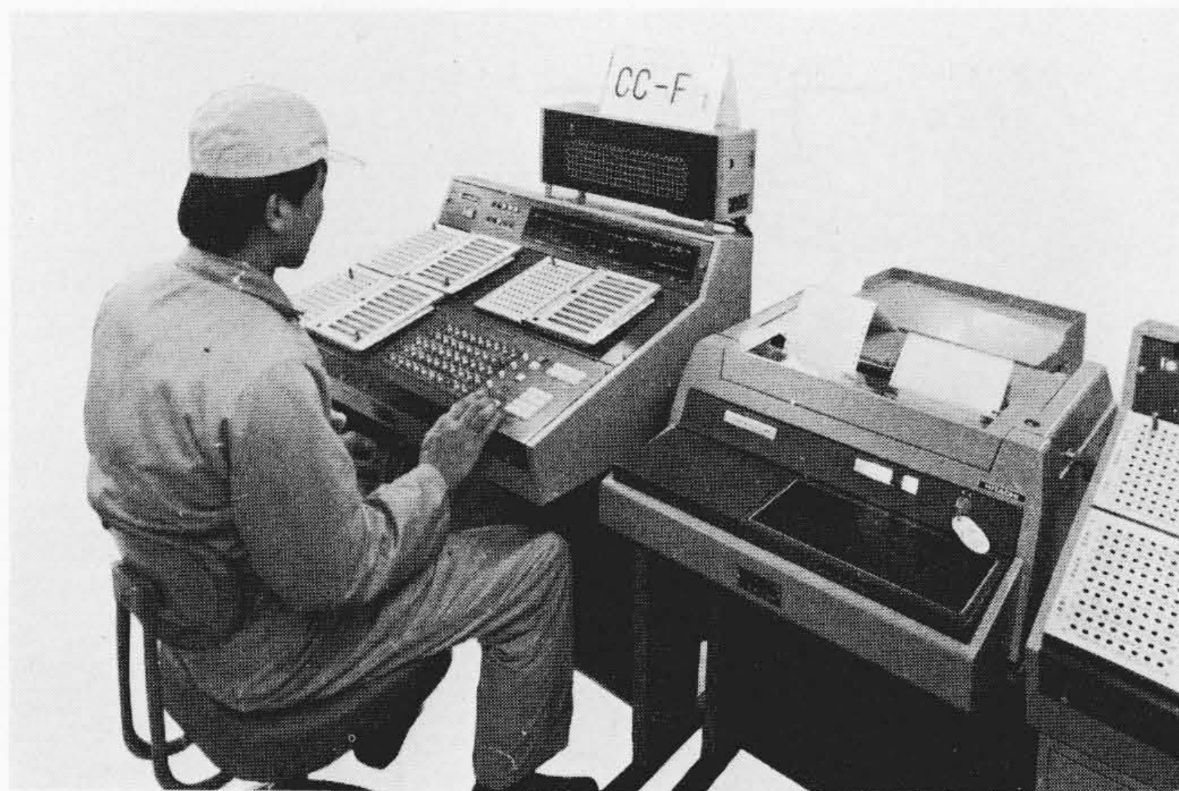
図4 N形端末装置 列車名、駅名入力はページ、日付などの入力はテンキー、操作種別などはフルキー方式である。
