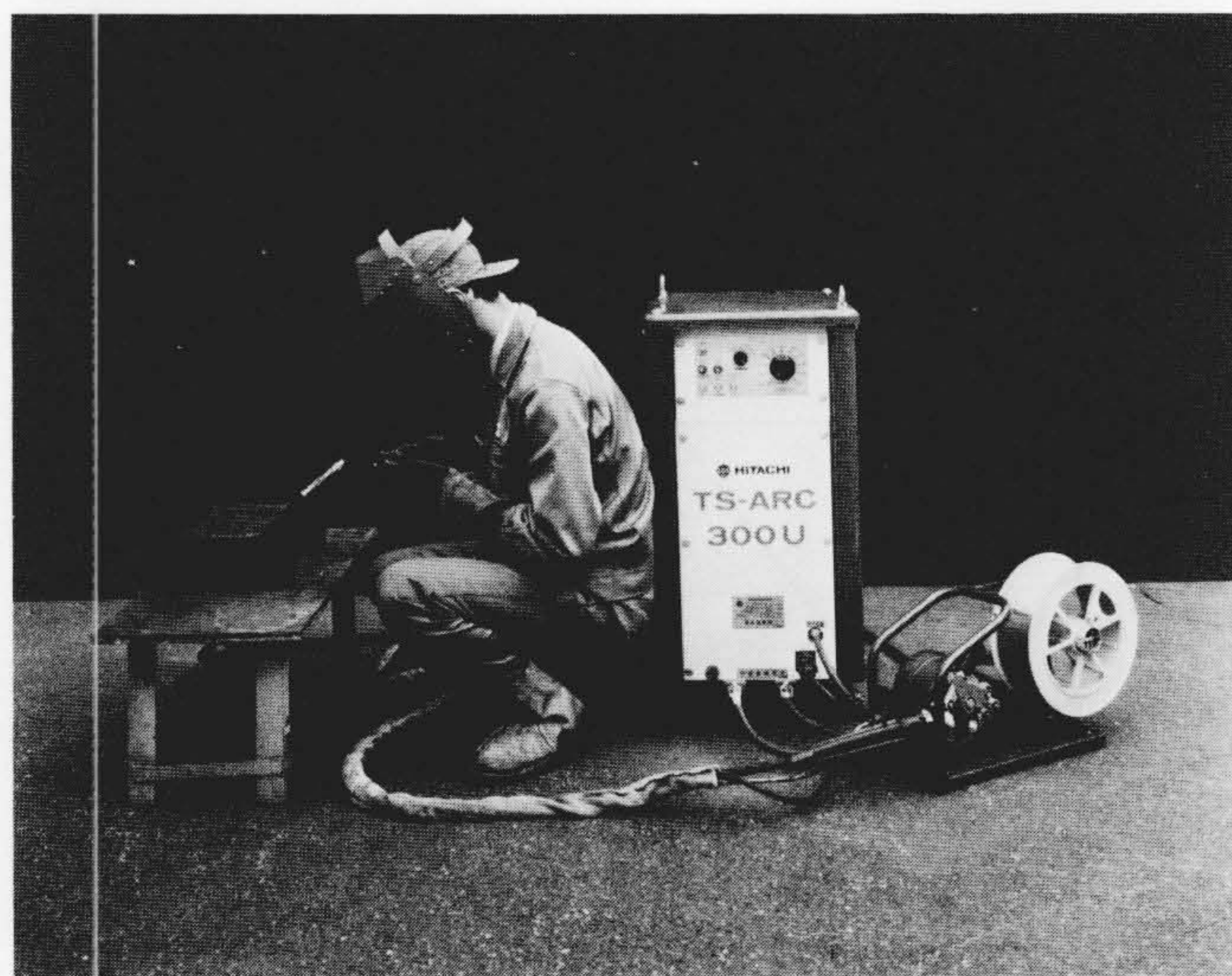
図1 日立TS-300Uシリーズ 溶接用電源、ワイヤ送給装置、トーチ その他付属品で構成される。
