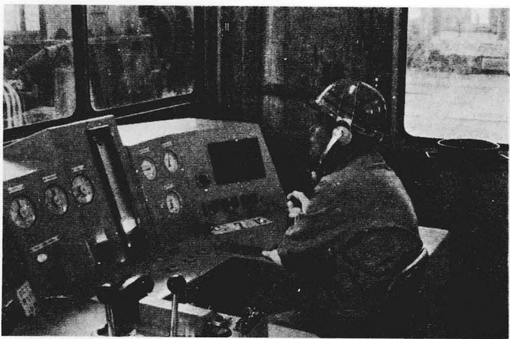
図5 運転デスク外観 2,400kW スキップ巻上機用運転デスクを示す。 Fig. 5 Control Desk
