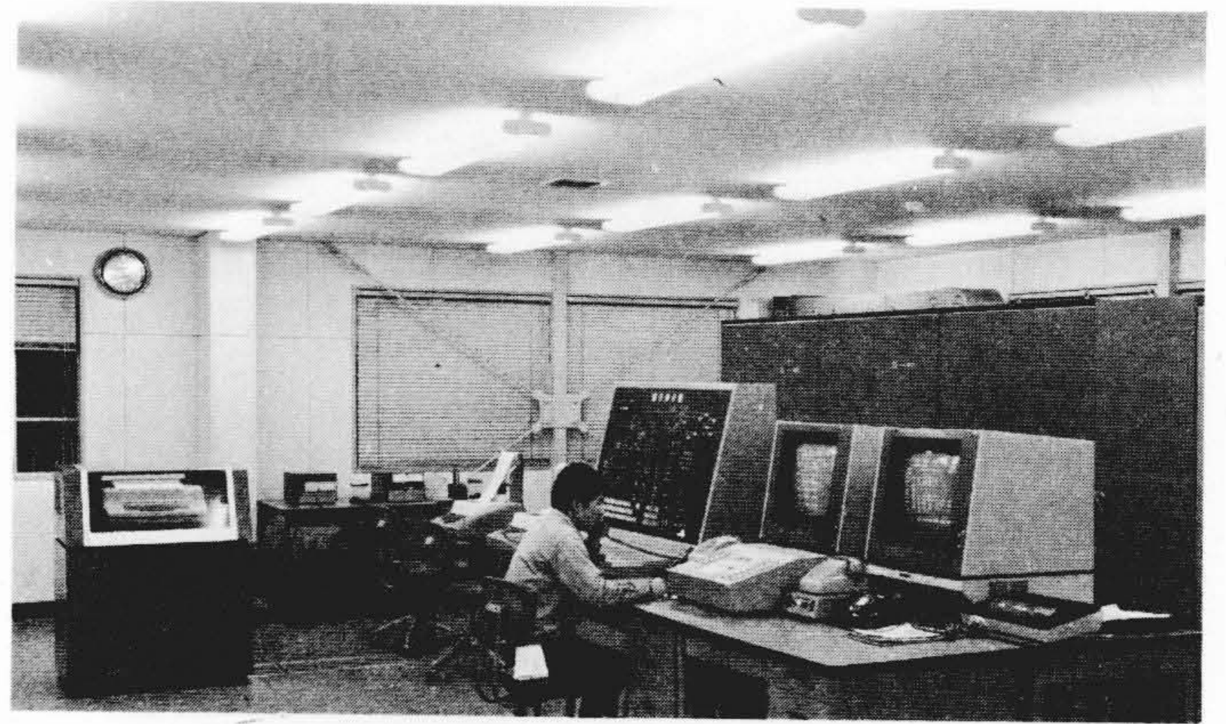
図5 輸送指令室の貨車運用管理システム 指令員は、2台のカラーディスプレイを介して貨車の運用を管理する。後方はディーゼル機関車無人運転システムの運行表示盤である。
