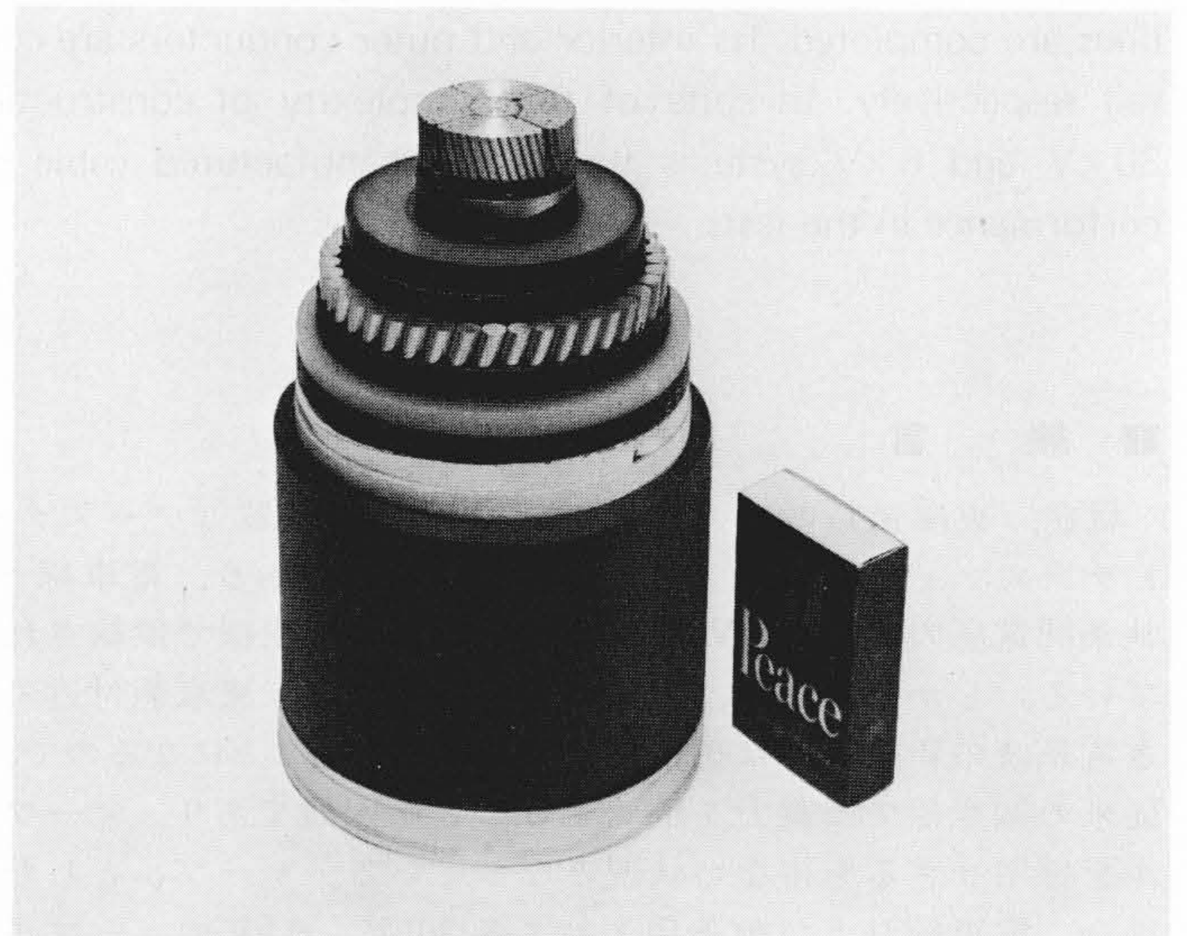
図1 同軸電力ケーブルの外観 内部導体、外部導体いずれも1,000mm 2 であり、ケーブル外径は105mmである。
