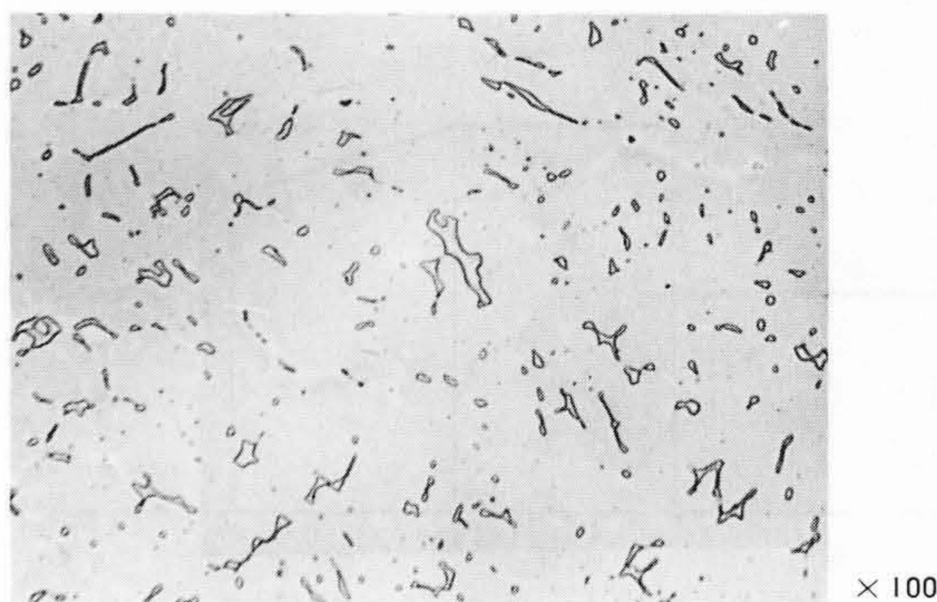
図15 ミクロ組織の一例 ジェットポンプノズルの代表的なミクロ組織例を示す。
