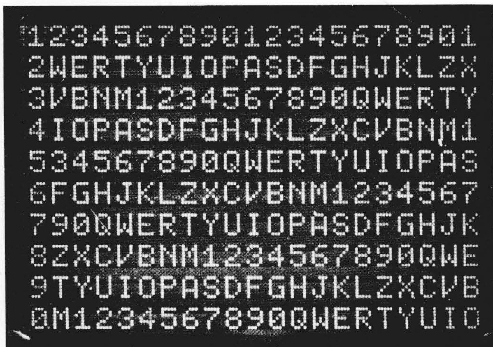
図13 文字表示例 液晶マトリックス表示装置に10行20字を表示した例を示す(走査線数70本)。
