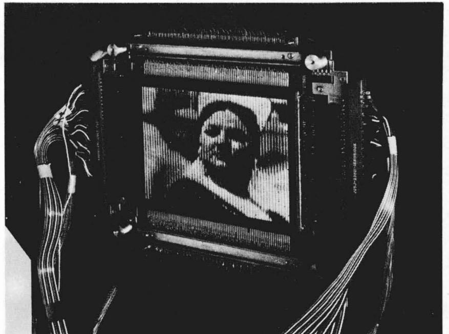
図8 カラーパネルによるテレビ画像の表示例 図7の駆動回路を用いてガス放電パネルにカラーテレビ像を表示した例であり、通常のテレビ画面の中央部1/4面積の範囲が表示されている。
