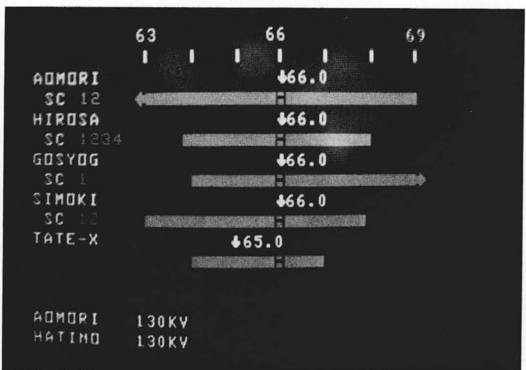
図4 CRTに表示されたグラフの一例 電圧監視点の上下限值、実測値及び設定値と並列コンデンサの投入状況を知ることができる。 Fig. 4 Graphic Characteristic Displayed on CRT Viewer
