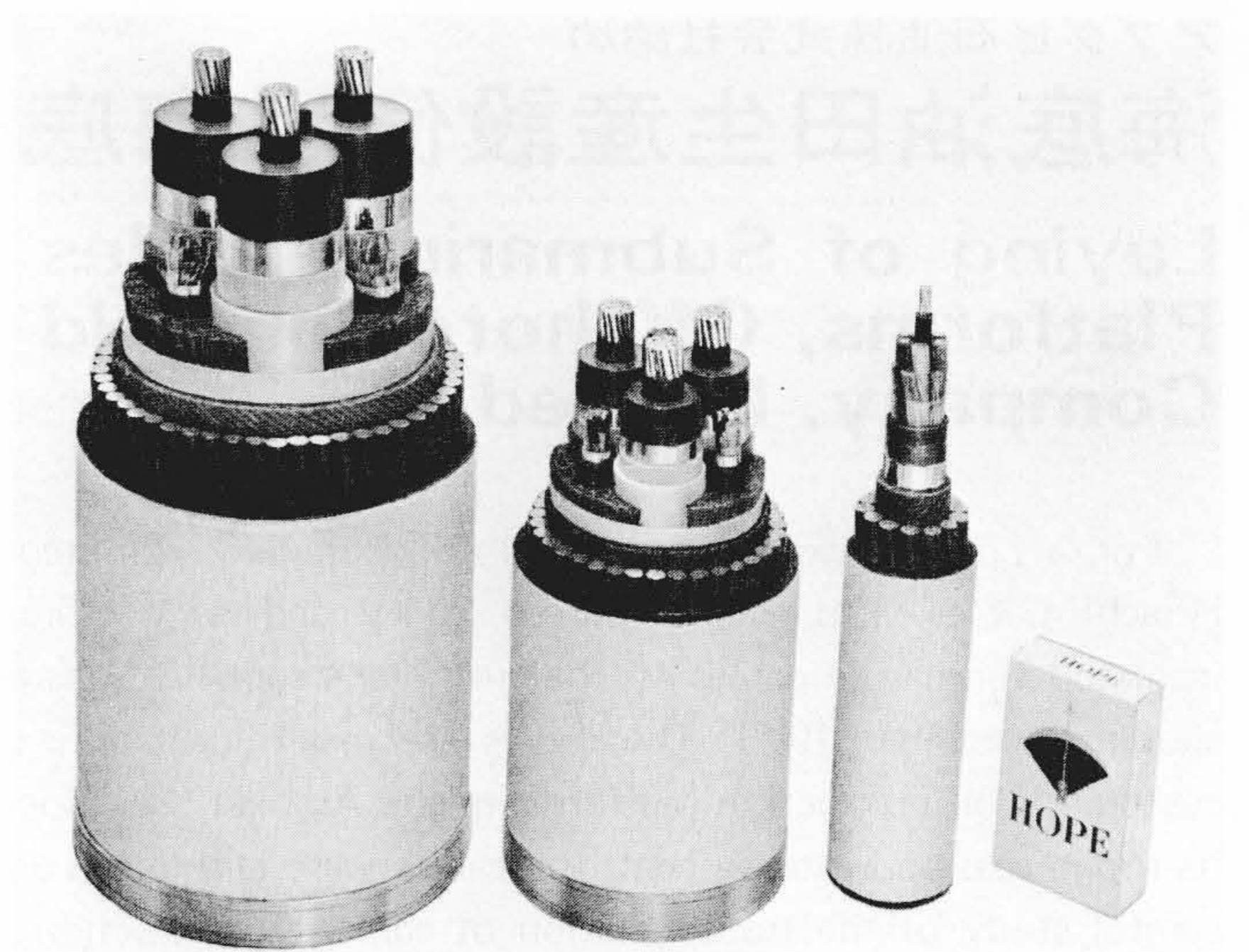
図2 ケーブルの外観 25kVケーブル(左)、8kVケーブル(中央)は、立上げ部構造を示す。海底部は電力線心上のビニルシースがない構造である。600Vケーブル(右)はフレア点火用で全長同一構造である。
