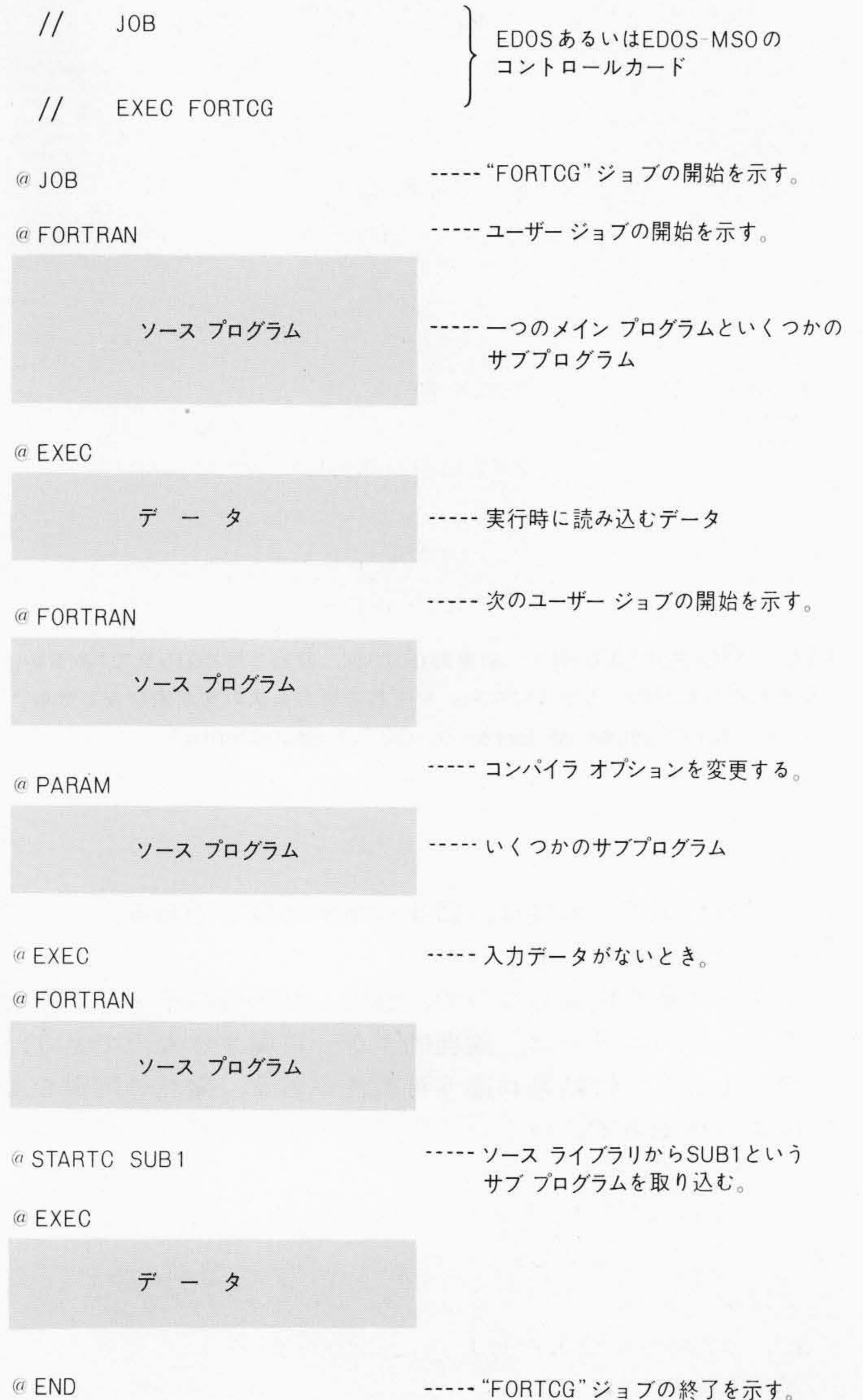
図5 “FORTCG”の連続処理の例 第1欄が@のカードを“FORTCG”のコントロールカードとして、いくつかのユーザジョブを連続処理する。
