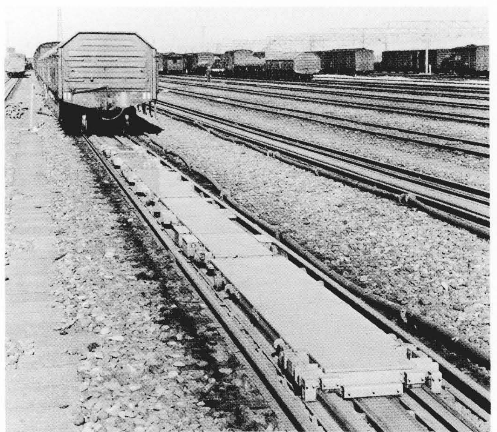
図2 リニア モータ カー リニア モータ カーの実物写真を示すものである。
