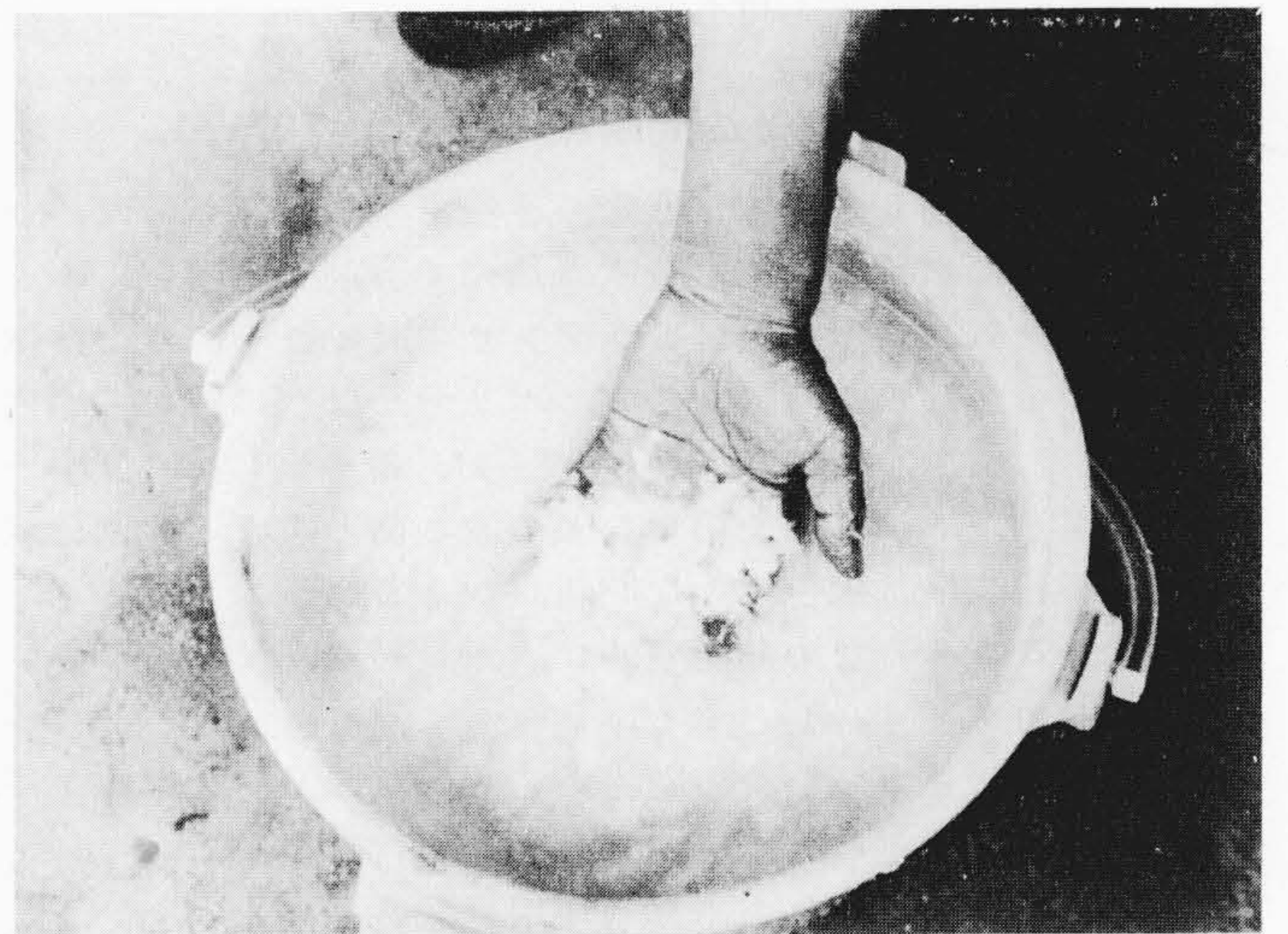
図2 ポリマーの析出状態 ポリマーが綿状のものになっている。ポリマーの濃度は10%程度である。
