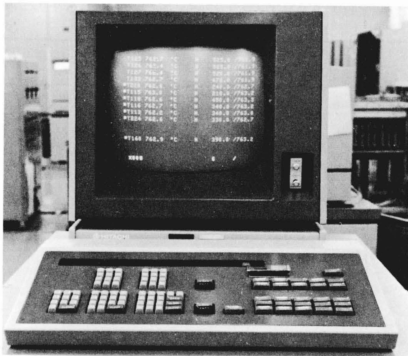
図4 カラーCRTディスプレイの表示例 従来、数表示器により1ループ分のTag No. とData程度を表示していたが、CRTの利用により同時に十数ループ分のTag No. とData及びパラメータなどを表示できる。
