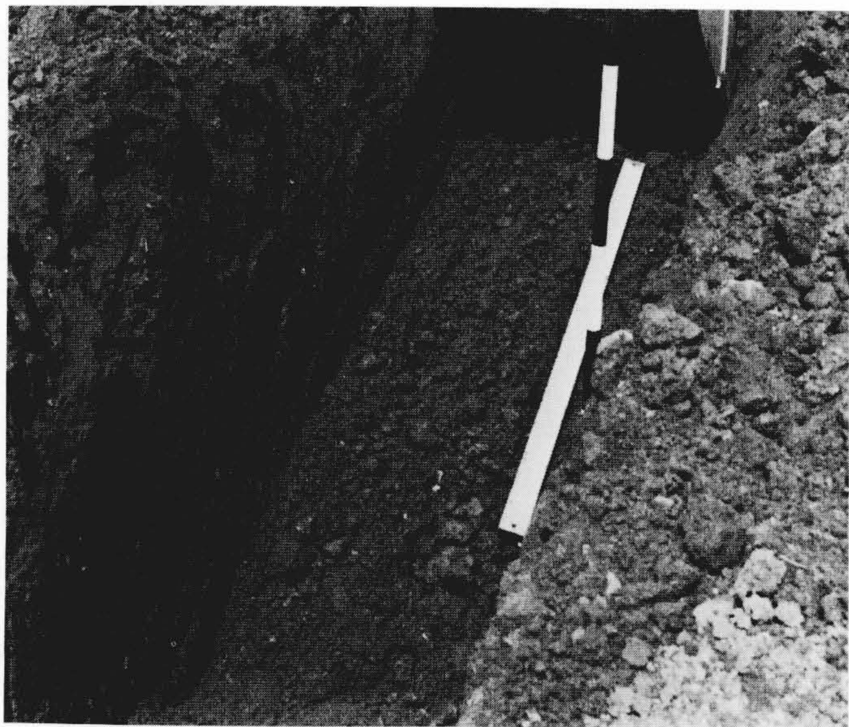
図7 掘削試験結果の一例 掘削面は滑らかで精度が良い。
