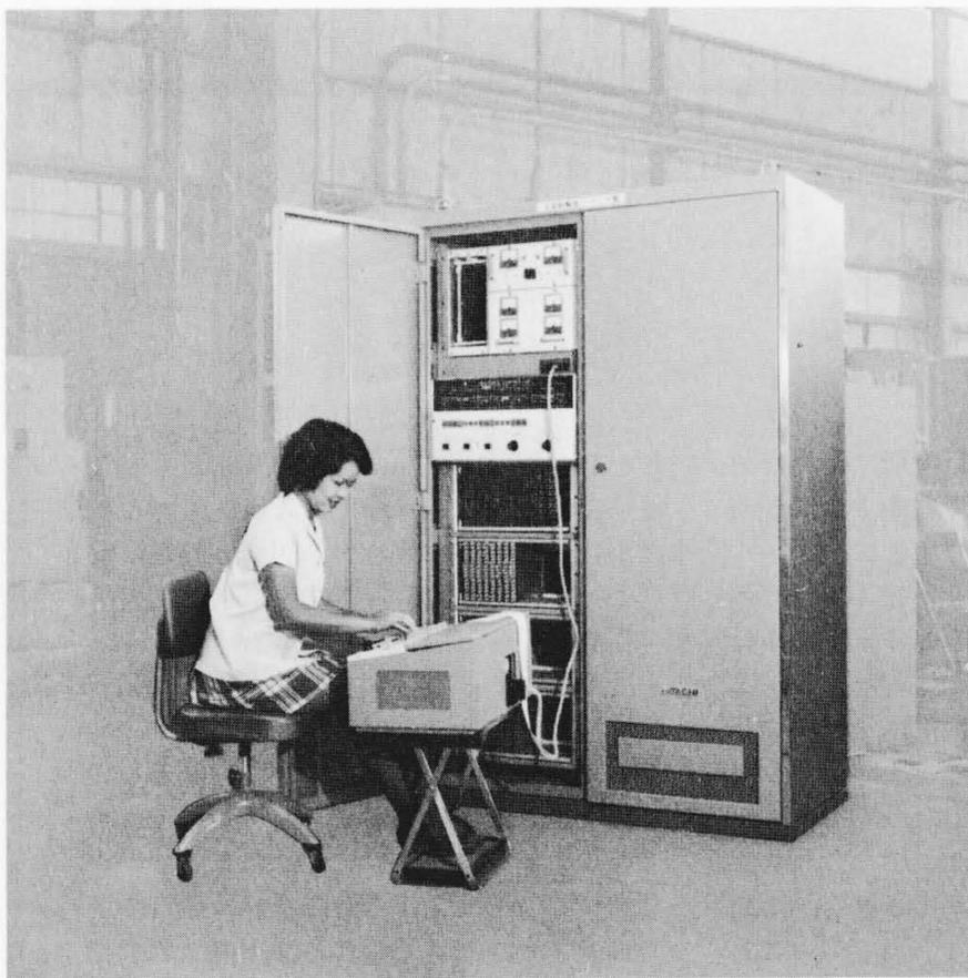
図6 日立シーケンス コントローラ“HSC-500” プログラムを行っている状態を示し、論理式どおりにキーを押していけばよい。
