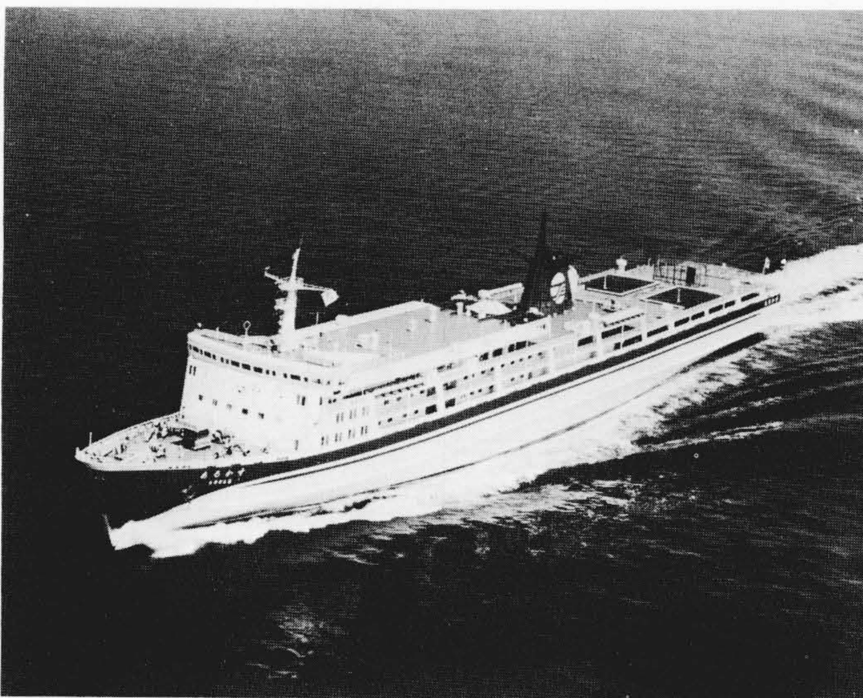
図1 太平洋沿海フェリー株式会社所属「あるかす」 湿式多板クラッチを内蔵した船舶用減速機を搭載した中速ディーゼル機関船(9,800総トン)である。
