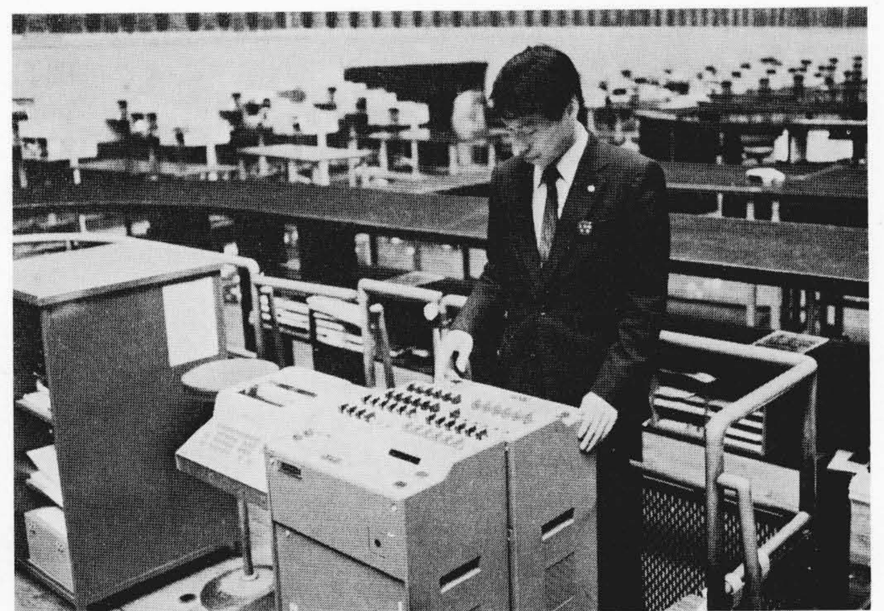
図3 東証キー入力装置 立会場のポスト内に設置されており、電子キーによって銘柄を選択し、約定値段・呼び値・売買高を入力する端末装置である。
