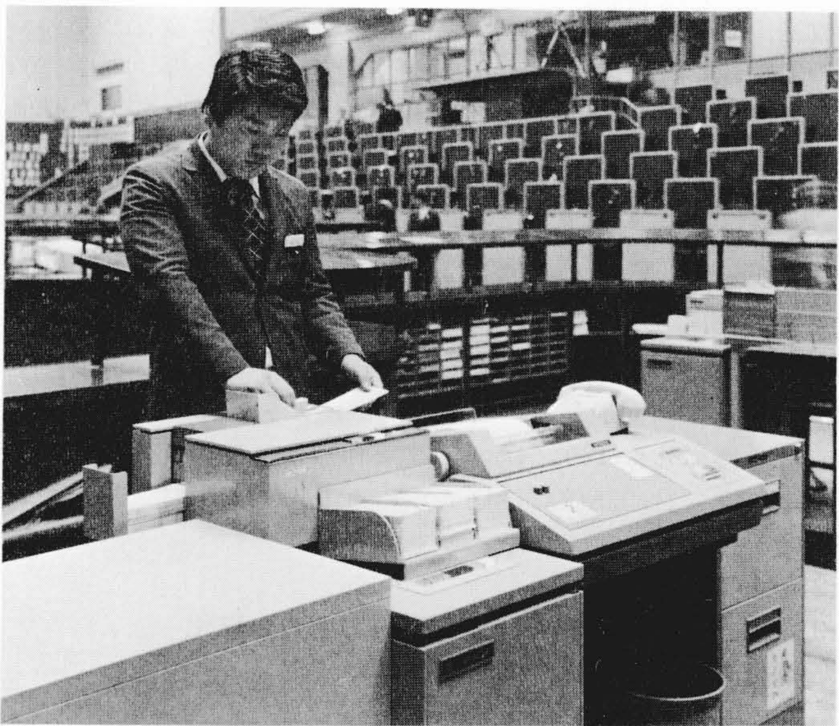
図5 大証カード入力装置 立会場内の各ポストに設置されて、株価を入力するマークカード読取機である。
