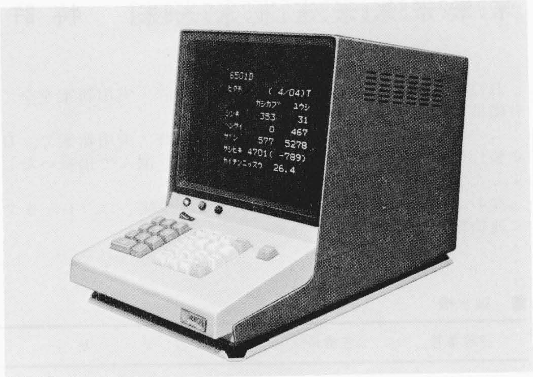
図6 H-9905ビデオディスプレイ装置 9形ブラウン管を使用したビデオディスプレイ装置で、だれにでも容易に操作できるように操作部は電子式卓上計算機並みに設計されている。
