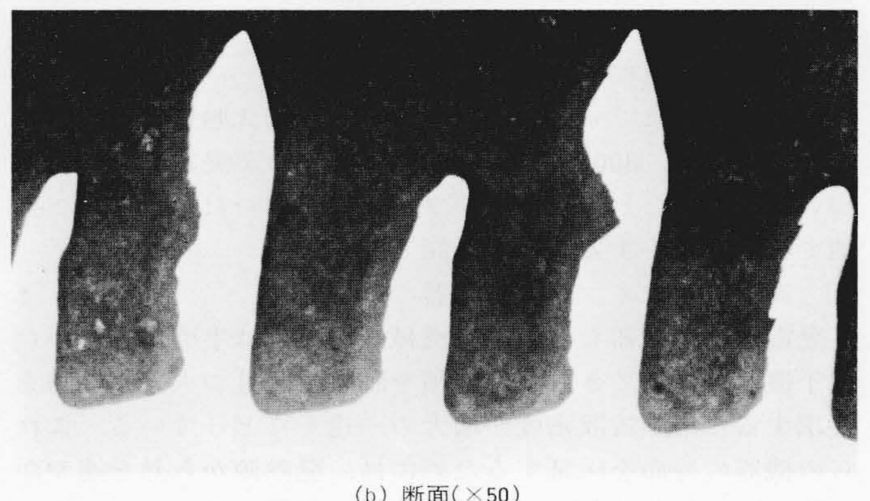
図8 「サーモエクセルC」の表面拡大写真 「サーモエクセルC」の顕微鏡写真で、のごぎり歯状の多数のフィンが直立している。
