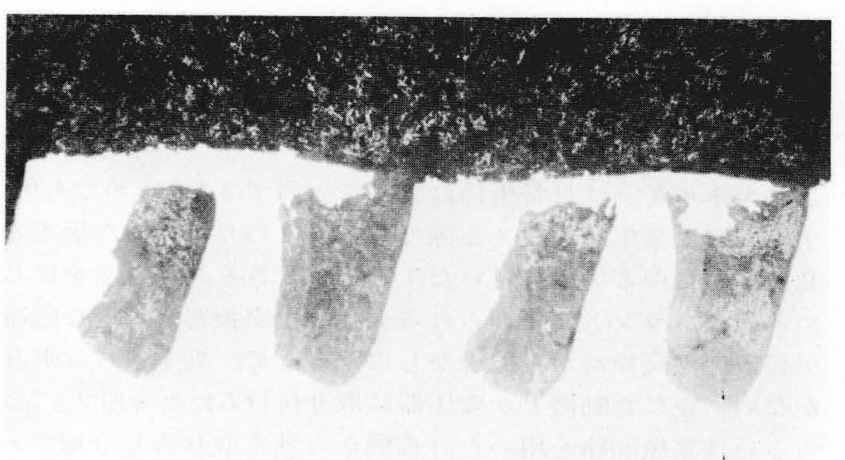
図5 「サーモエクセルE」の表面拡大写真 「サーモエクセルE」の顕微鏡写真で、伝熱面のトンネル内部及び細孔状態を示す。
