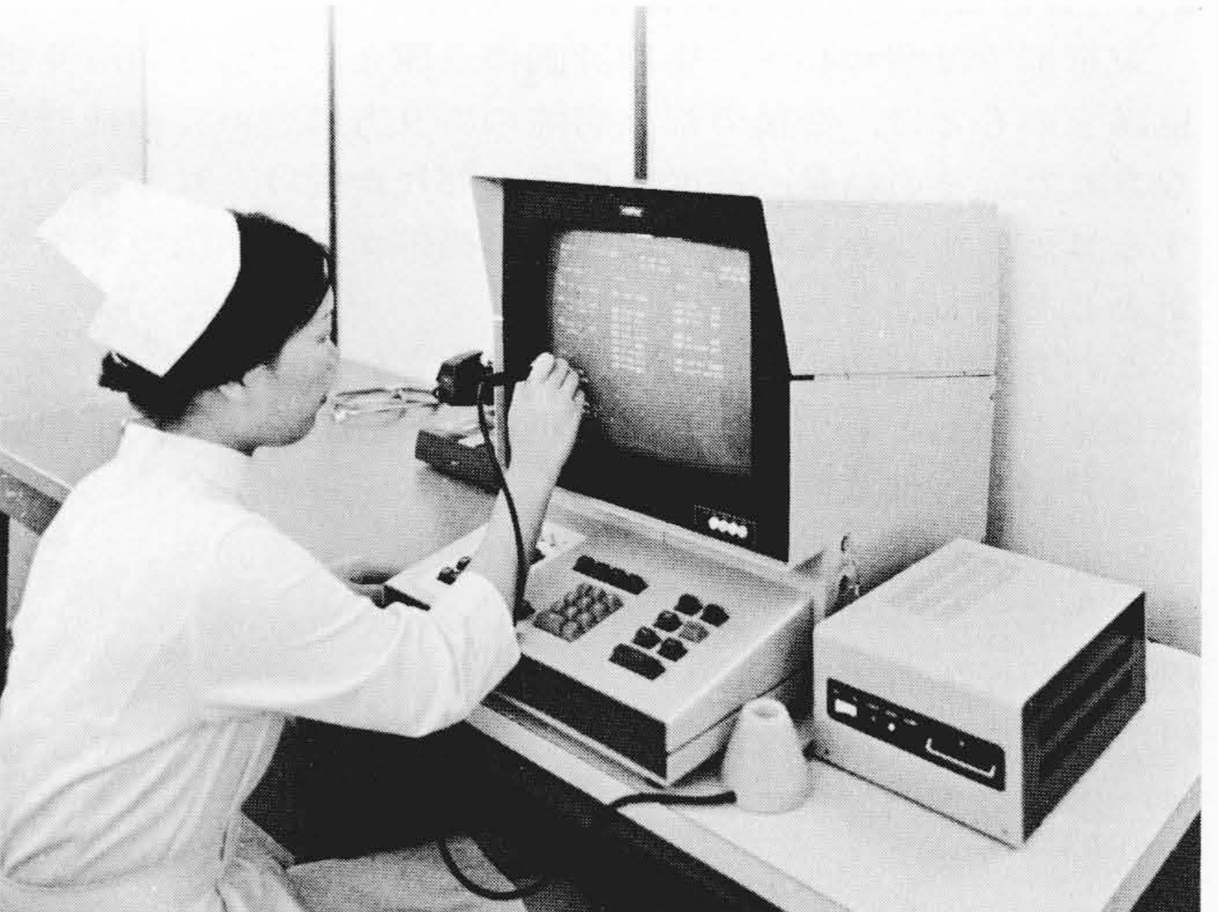
図2 ディスプレイ端末装置 本装置は、患者のID(Identification)カードを読み取るIDカード リーダと表示データを選択するライトペンが付いた1,920文字表示のキャラクタ ディスプレイ装置である。
