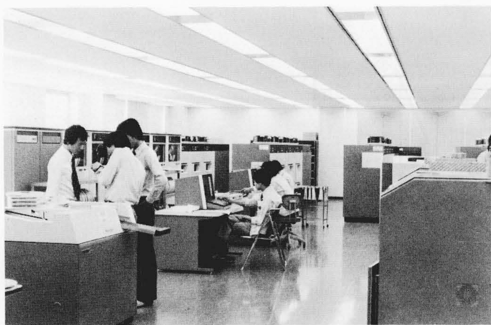
図2 HITAC 8700システム 本システムには、膨大な契約データを格納する大容量記憶装置が接続されている。
