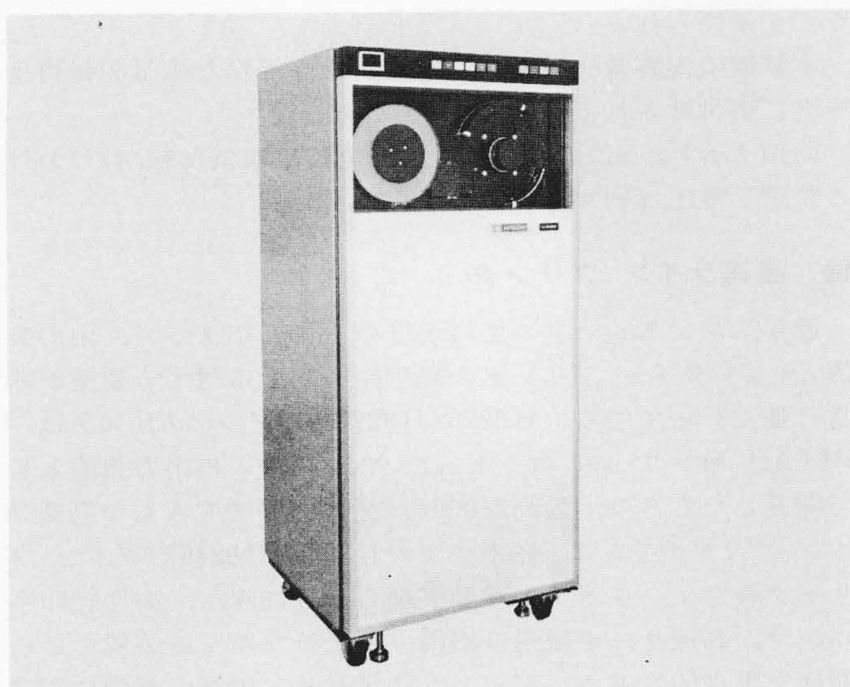
図3 H-8488-1磁気テープ装置 右側のテープ装着部にテープ リールを取り付け、ボタンを押すだけで自動的にテープは左側のリールに巻き付き、約7秒で動作可能となる。
