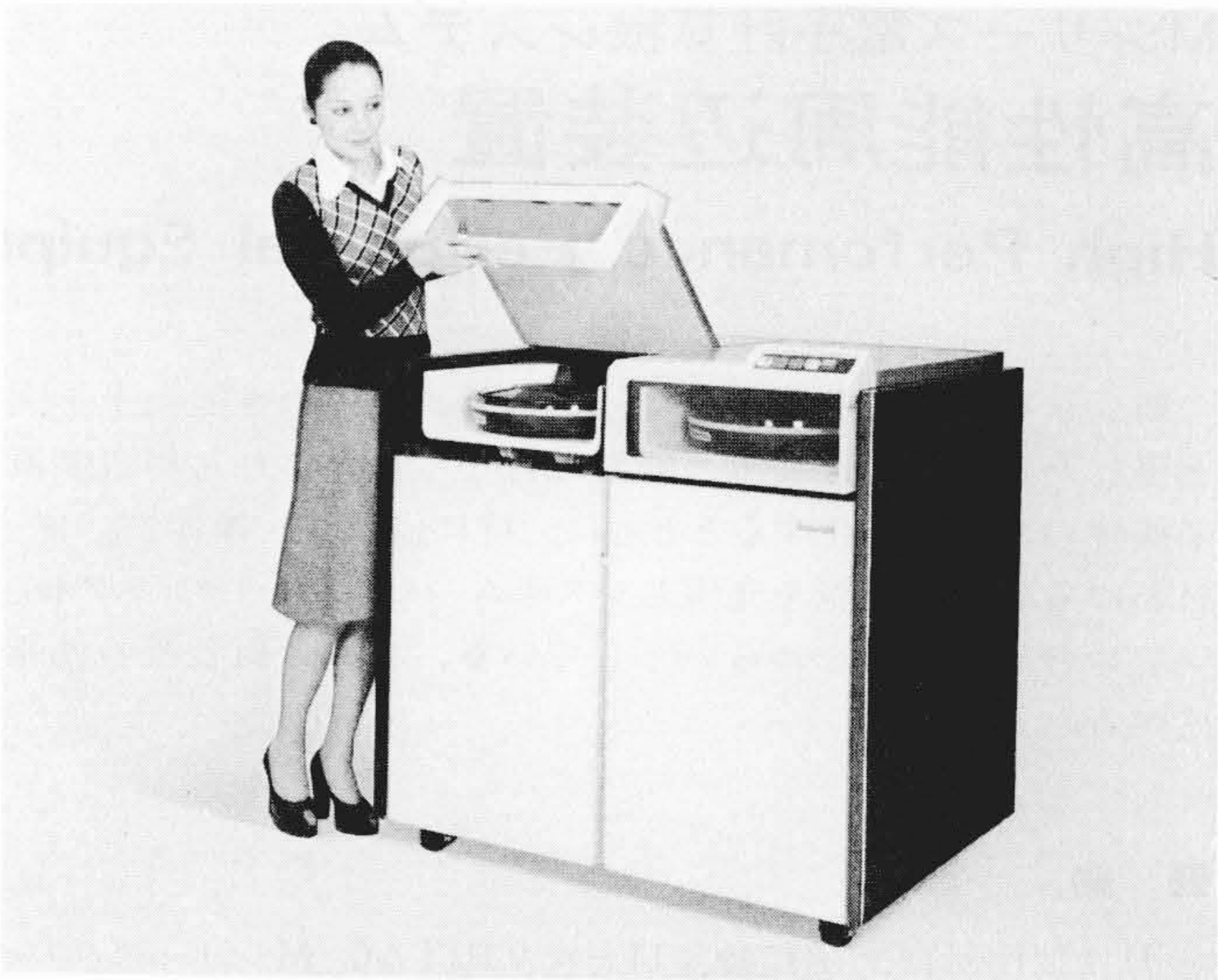
図2 H-8586-12/H-8586-22ディスク駆動装置 データ モジュールが実装されている状態を示す。上部カバーを開くことにより、簡単にデータ モジュールを交換することができる。
