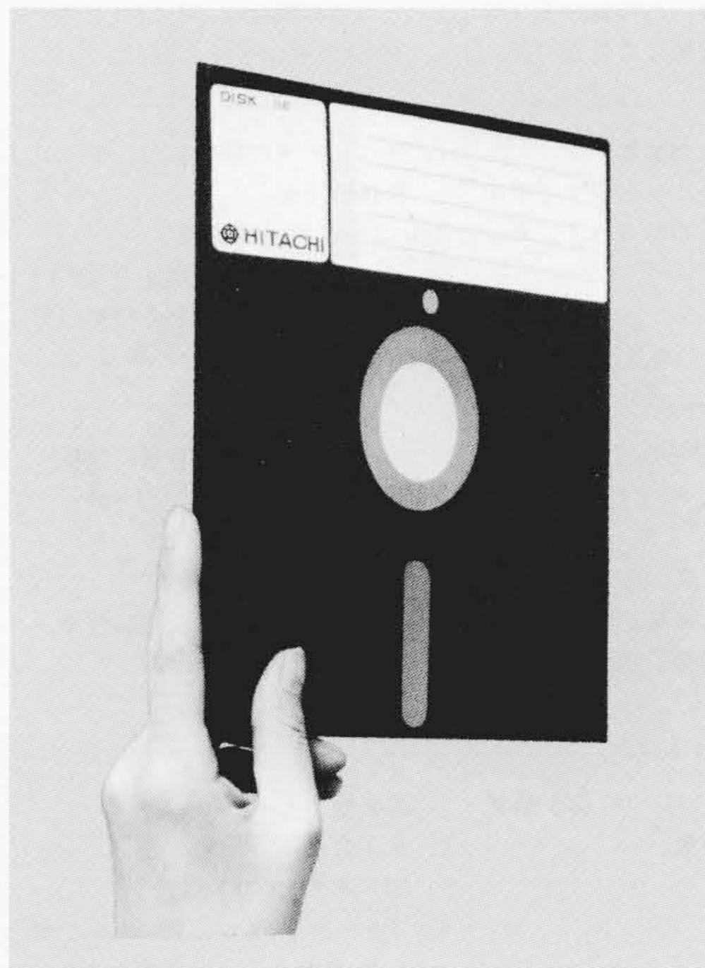
図1 フロッピー ディスク 一辺25cmの正方形のジャケット内に磁気円板が収納されている。カード約2,000枚のデータ記録が可能である。
