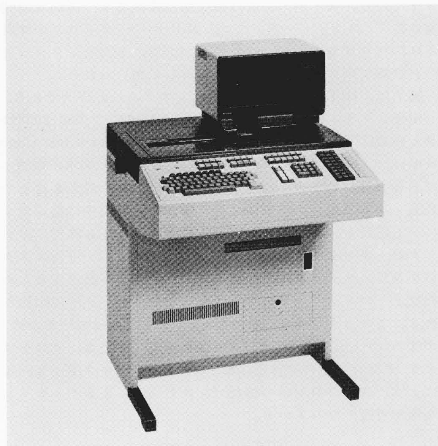
図8 T-5821窓口装置 通帳行自動セット装置により、オペレータは操作が容易となる。
