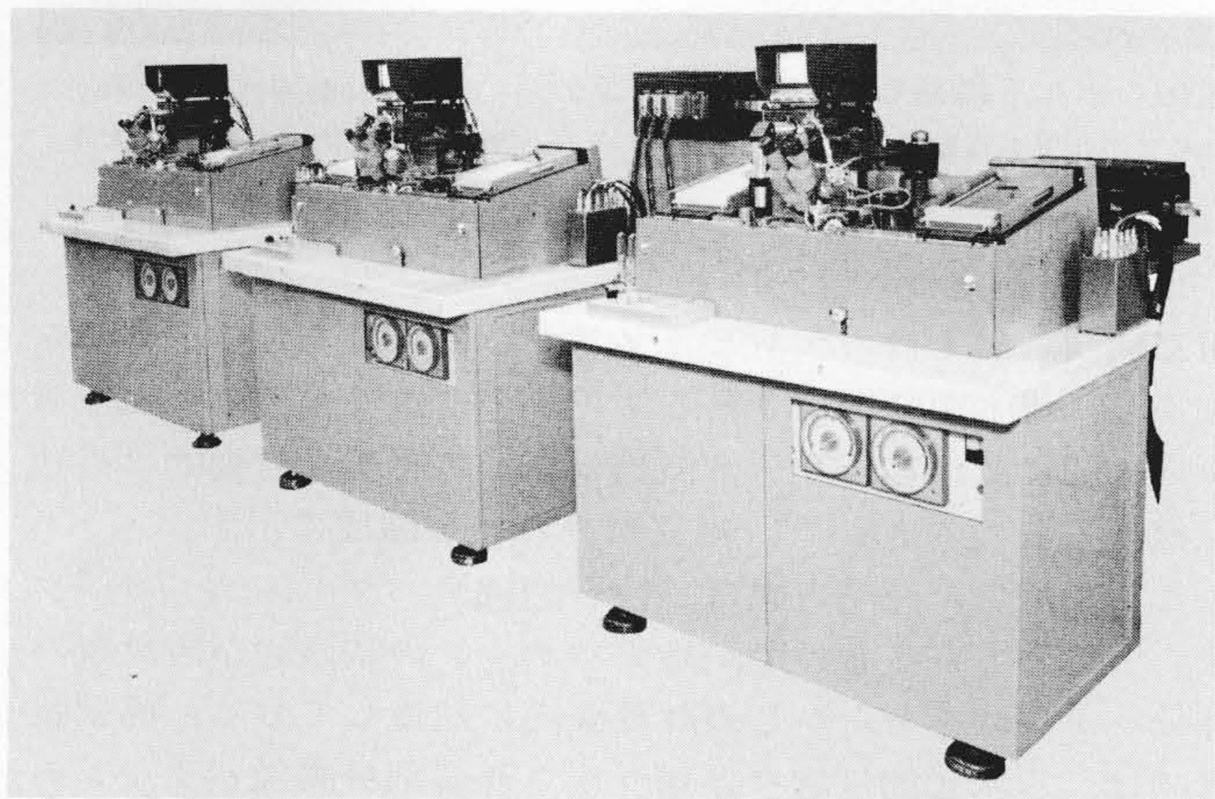
図12 トランジスタ自動組立機 テレビカメラの視野に入るチップの位置を自動的に認識し、その電極と外部リードとの間に高速配線を行なう装置である。
