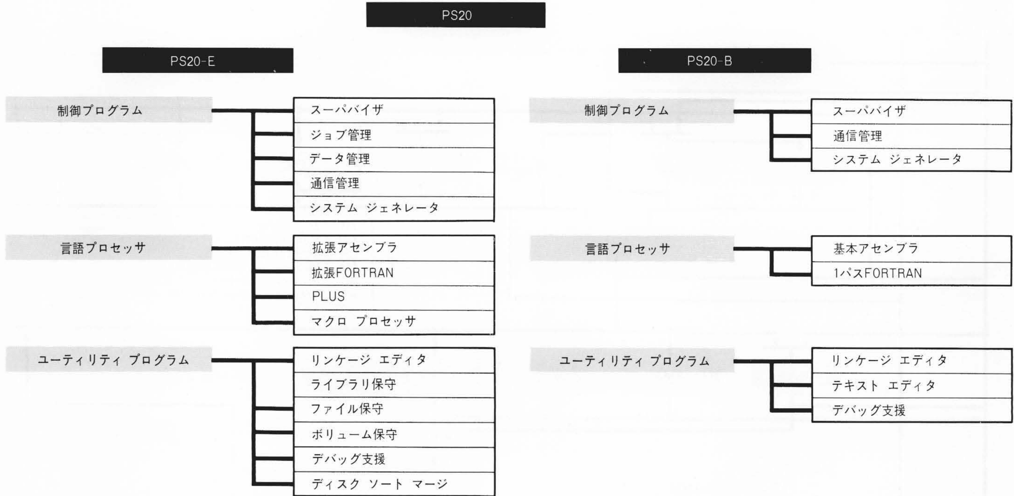
図 3 PS20ソフトウェア体系 HITAC 20のコントロール プログラムPS20のソフトウェア体系を示す。
