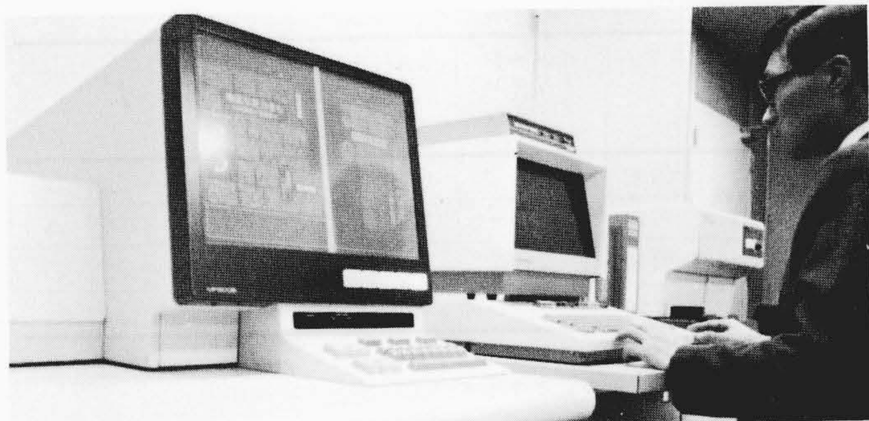
図1 “HIPACS”のシステム構成例 タイムシェアリングシステムに接続した機器構成を示すもので、左側がMP-600B形マイクロフィッシュ検索機、中央上側がHM-9840形キャラクタディスプレイ装置、同下側がHM-9830形端末制御装置及び右側がT-101形ビデオライタである。
