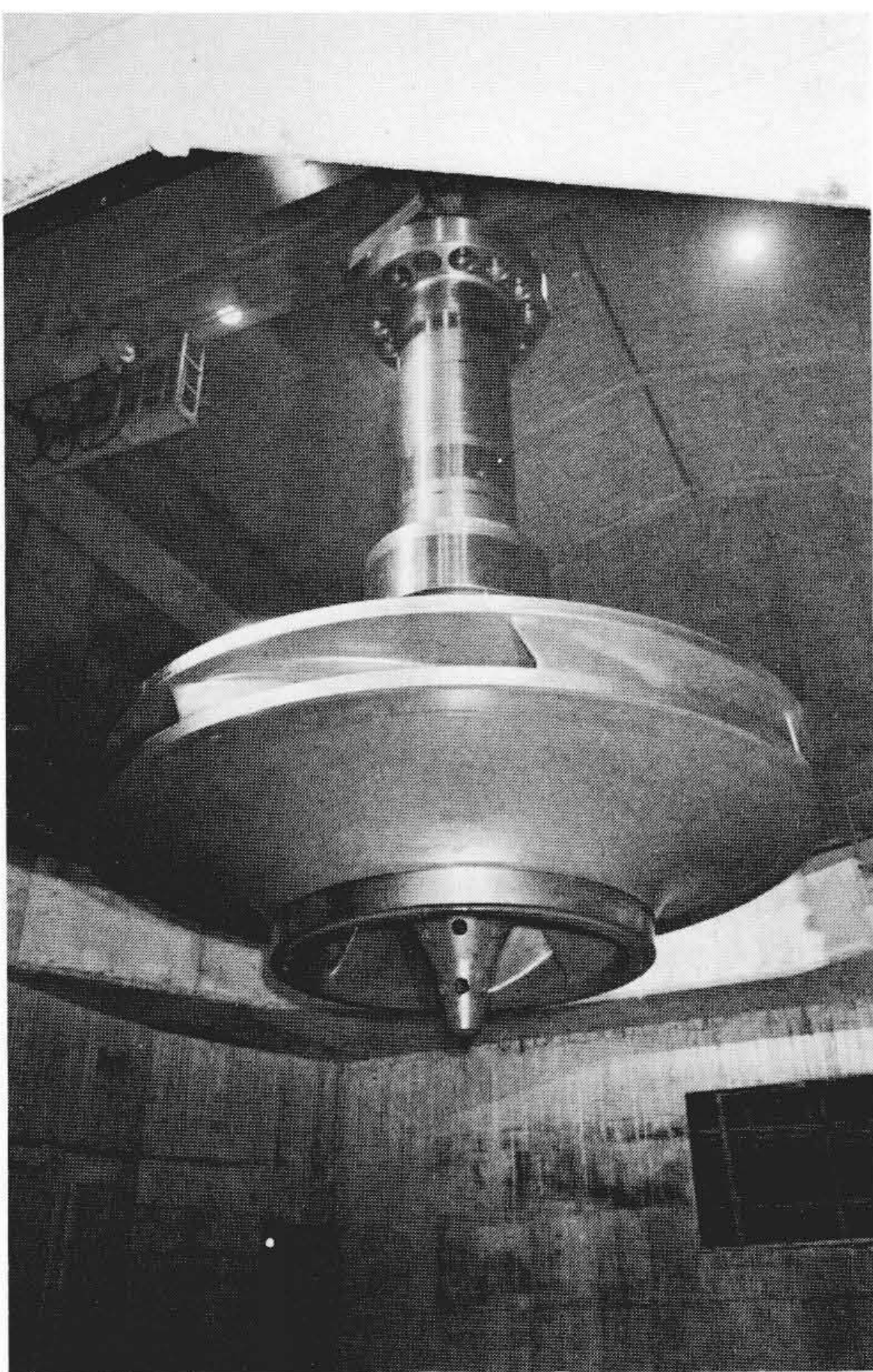
図9 九州電力株式会社大平発電所納め256MWポンプ水車
