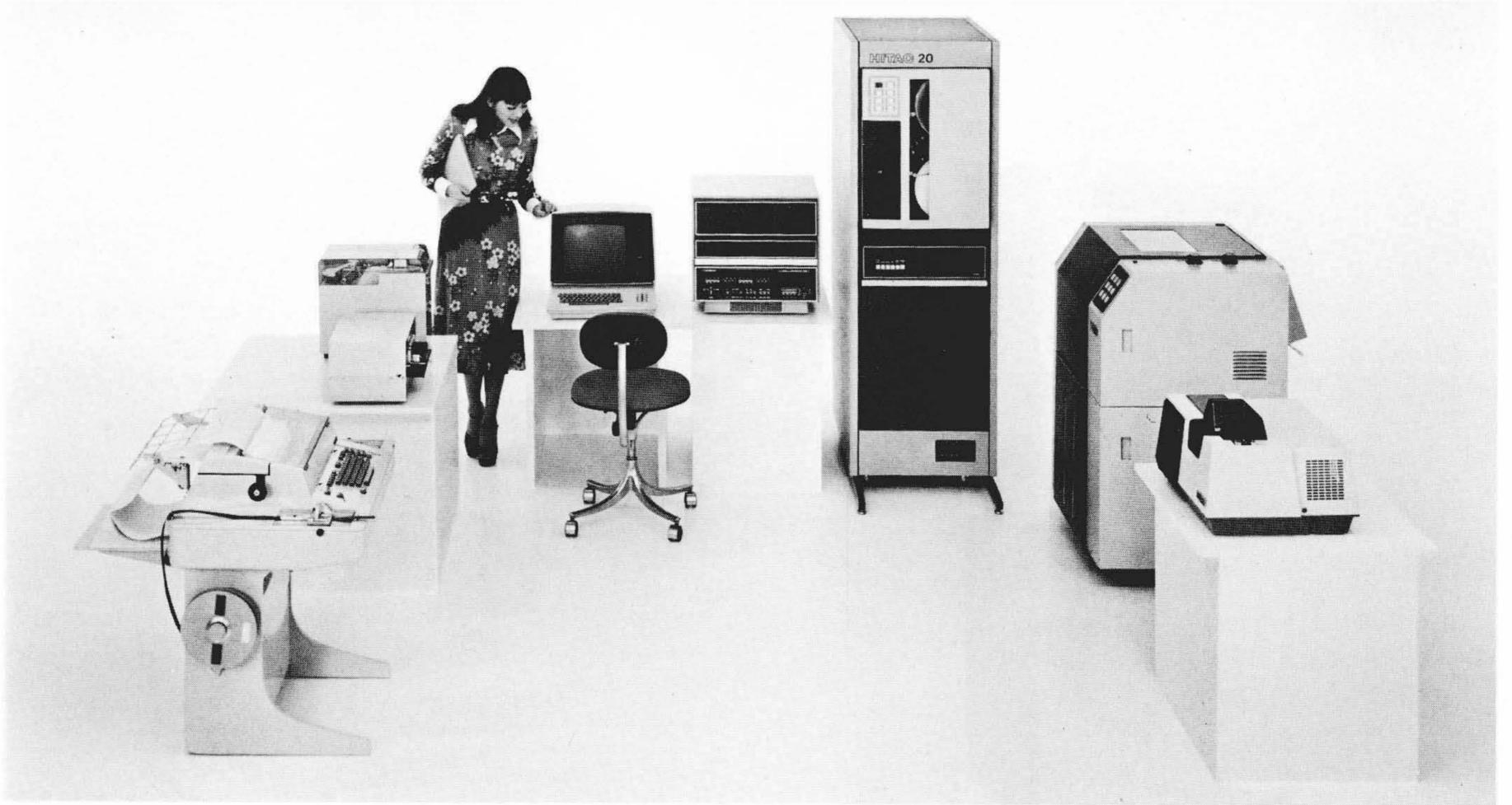
図9 HITAC 20ミニ コンピュータ
