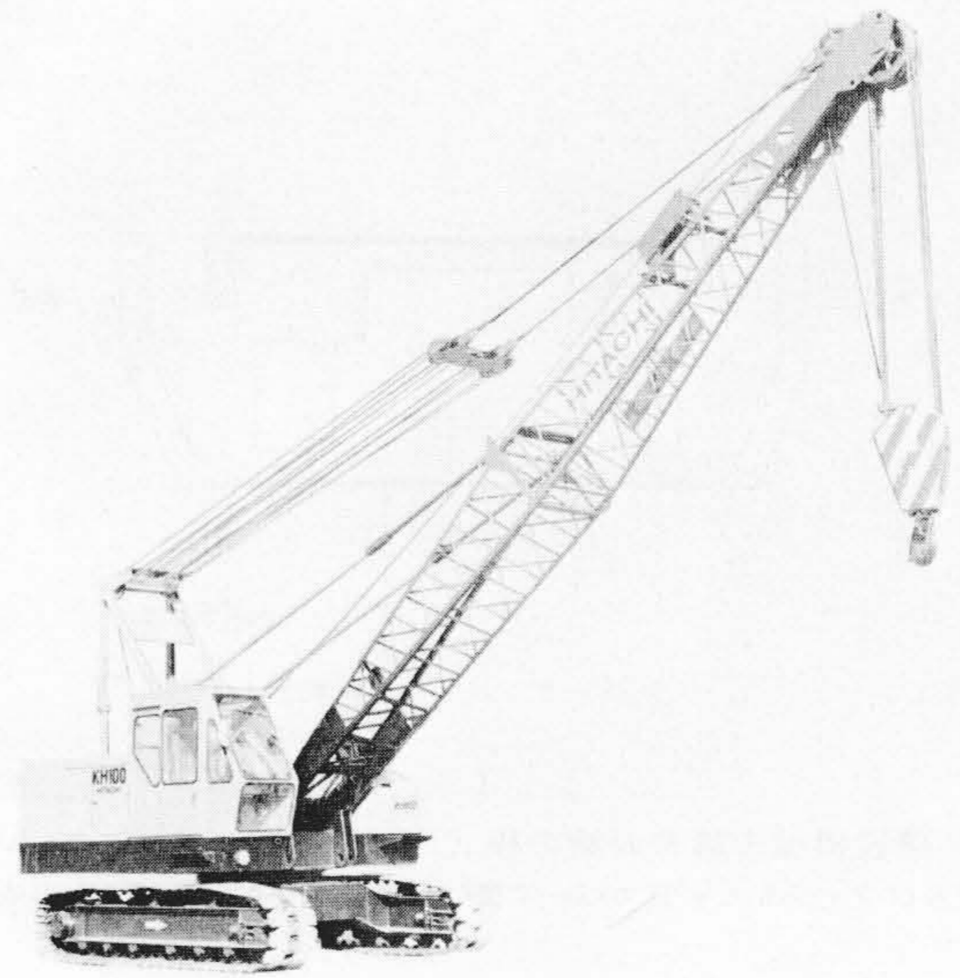
図7 KH100全油圧式クローラ クレーン つり上荷重30t, 自重29.3 tで操作性の良い全油圧式クローラ クレーンである。
