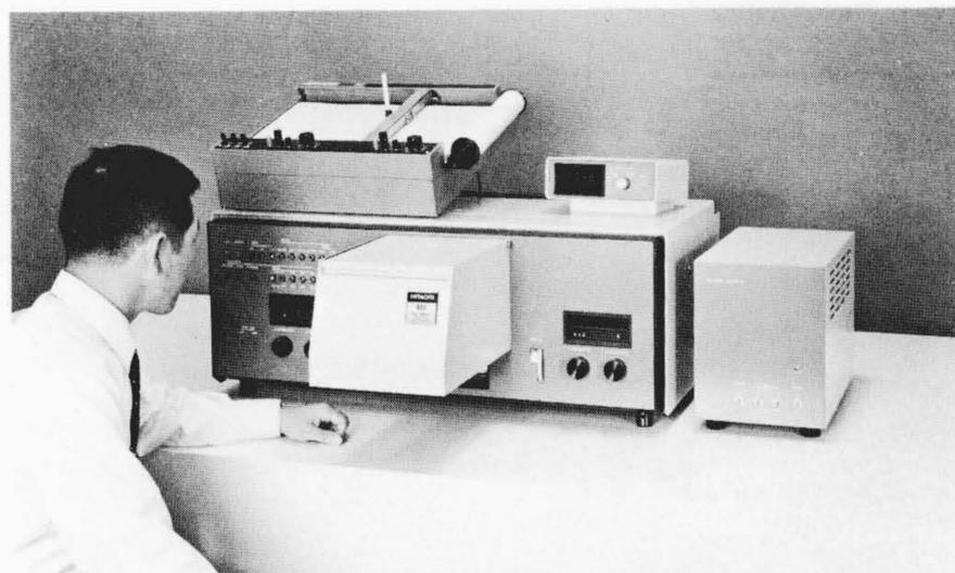
図1 556形二波長自記分光光度計 操作性を良くするため、つまみ類を1個所に集めた。種々の付属装置が装着できるよう、試料室は着脱が可能である。
