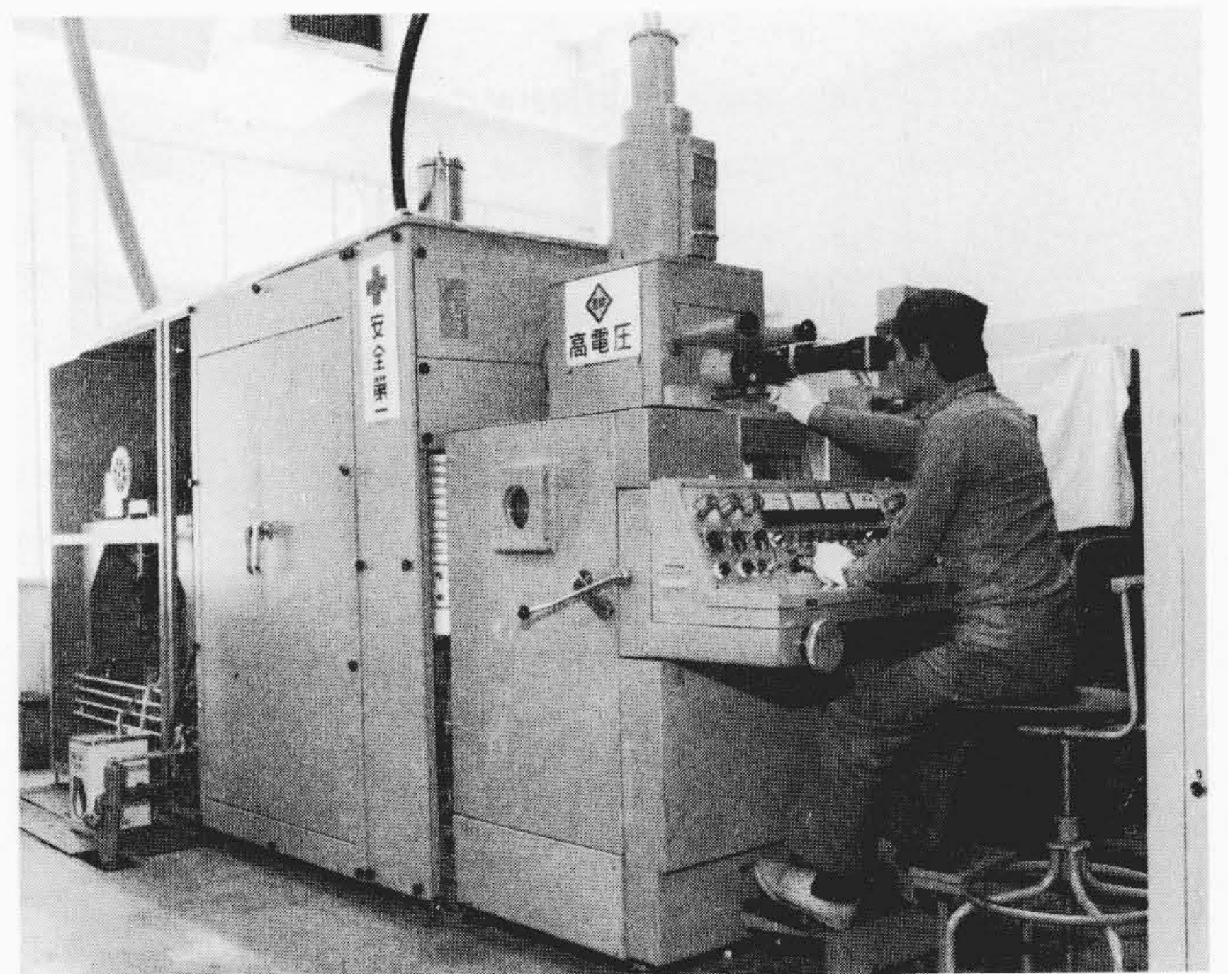
図1 電子ビーム溶接装置 日立製作所内に設置されたEB溶接装置の一例で、作業中の状況を示す。装置の保守管理と作業環境の維持には十分な注意を払っている。
