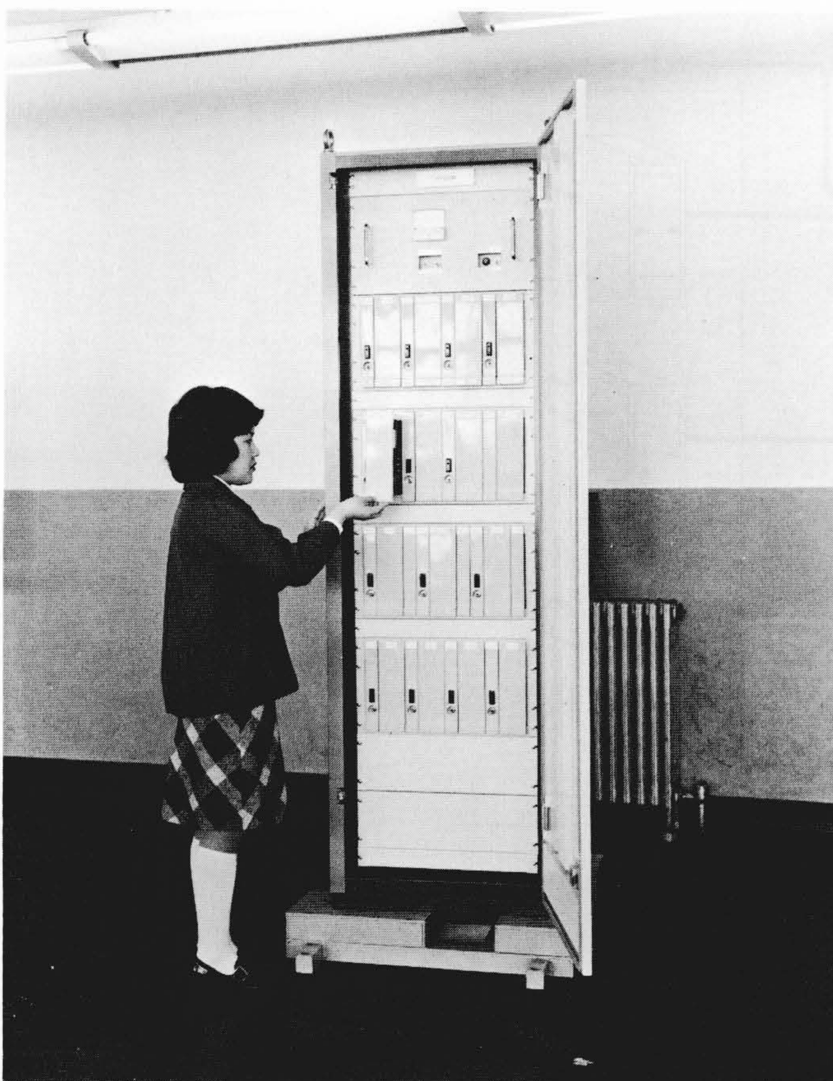
図2 アナログ ラックの外観 最上段はDC 24V用電源ユニット、その下段にI/Oモジュール、各種演算モジュールが配置されている。
