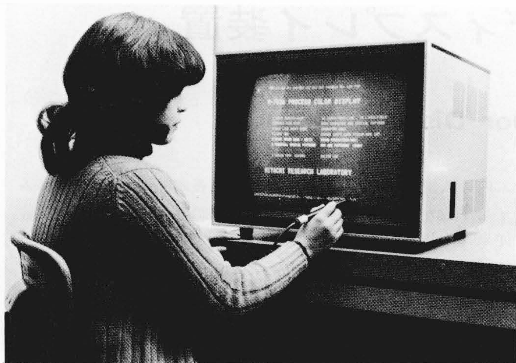
図2 H-7836プロセス カラー ディスプレイ装置 ライトペンを操作して、データを入力しているところを示す。
