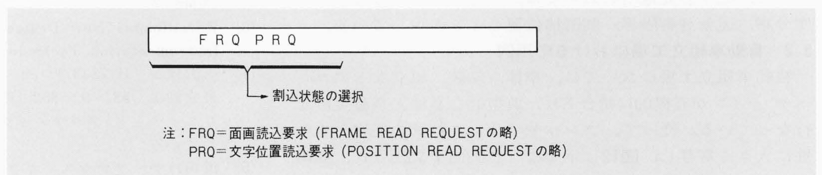
図9 割込状態表示例 ライトペンで割込状態を指示するため表示されている。
