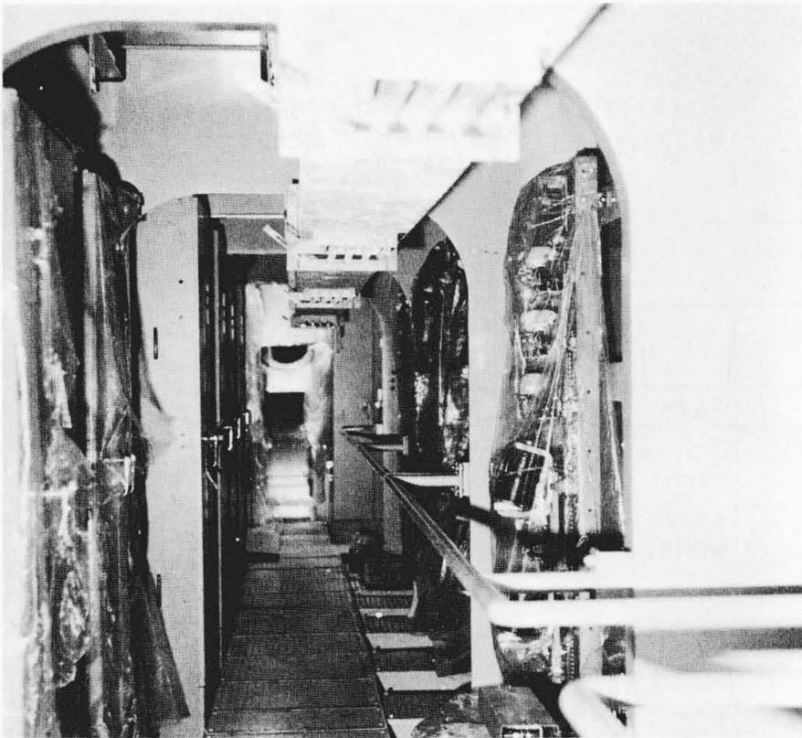
図3 ガーダ内電気品室(工場内組立状況) 工場でガーダに組み込まれた電気品は、このまま発送される。ガーダ内は十分なスペースがあり、保守点検が安全に行なえるよう考慮されている。
