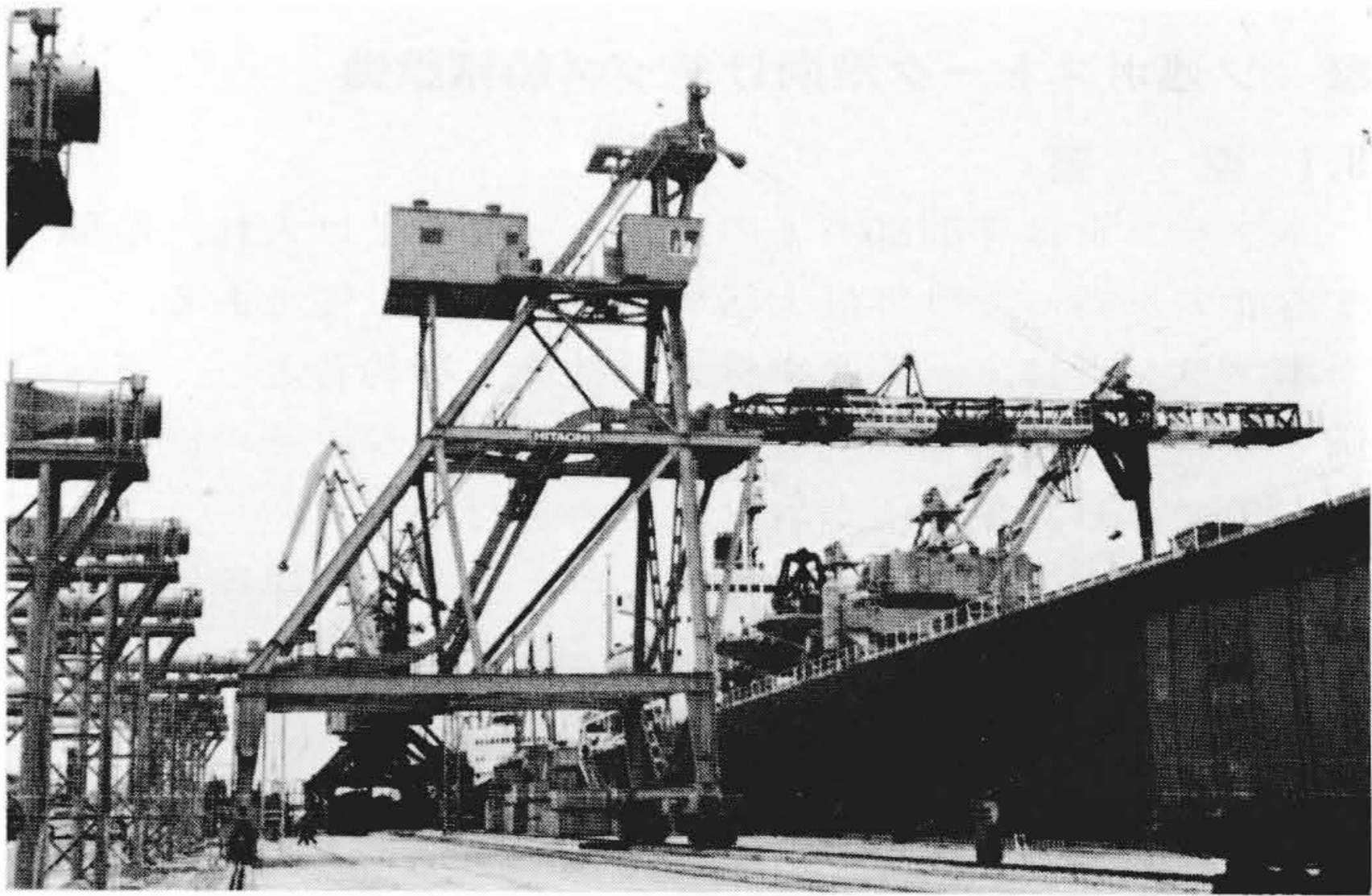
図11 シップ ロード設備 チップ船積中のシップローダの全景を示す。
