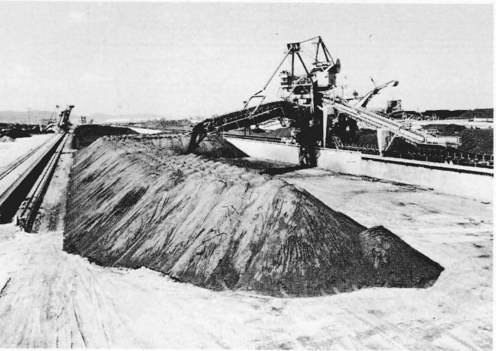
図2 4,800t/hスタッカ 本機は遠隔自動運転によってヤードに積付を行なう。
