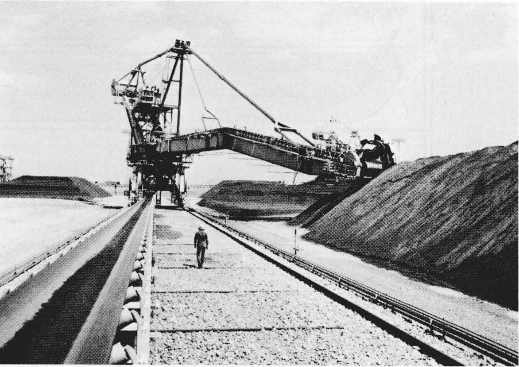
図3 1,350t/hリクレーマ 走行を油圧駆動とし、寸動動作の精度を確保して自動運転に備えた。
