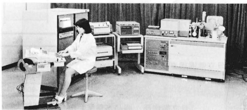
図1 002B形データ処理装置と接続されたM-52形日立GC質量分析計
