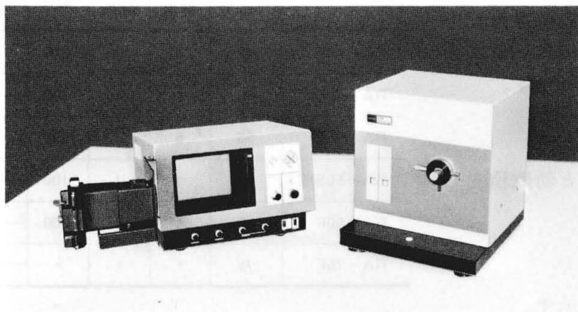
図1 S-310形走査電子顕微鏡
