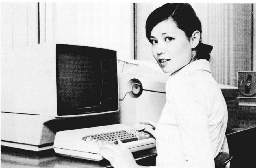
図6 H-9415ビデオ データ端末装置 画面上のフィード制御機能によりデータの誤入力防止が可能とし, 優れたマン マシン インタフェースをもつビデオ端末である。
