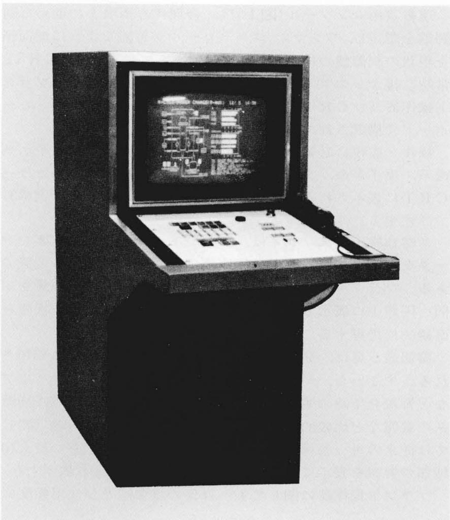
図2 当直長用コンソール 運転員の操作とプラント状態の監視ができ、必要に応じて操作をブロックすることができる。
