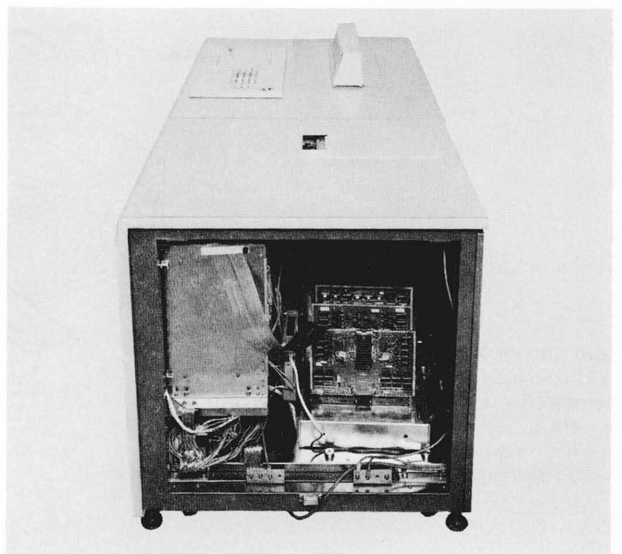
図14 事務機に実装した磁気バブルメモリ装置 ドラムを外し、磁気バブルメモリ装置(右側に見える3枚のプリント基板)を実装した。
