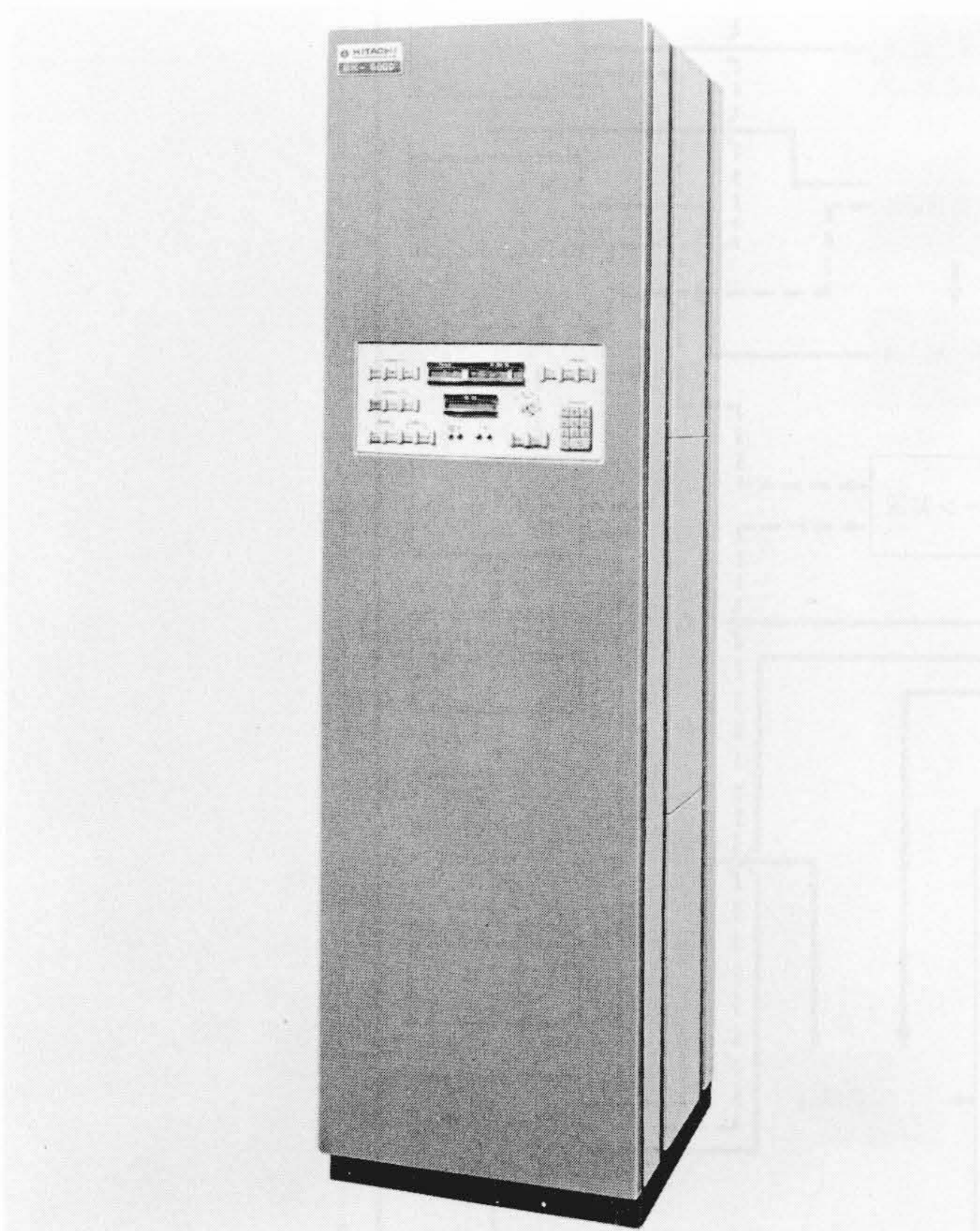
図7 日立500型ビル管理システムの中央監視制御装置外観 最大管理点数が500点であり、制御、監視、計測などの点数配分は、任意に選択できる。また、操作パネルはラックから外して卓上などにも設置でき、グラフィック表示パネルを別に設けられる〔外形寸法：幅570×高さ1,960×奥行480(mm)〕。
